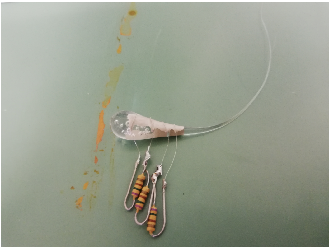
Slika 3.5: Rupertova kaplja na koju su spojeni kontakti.
