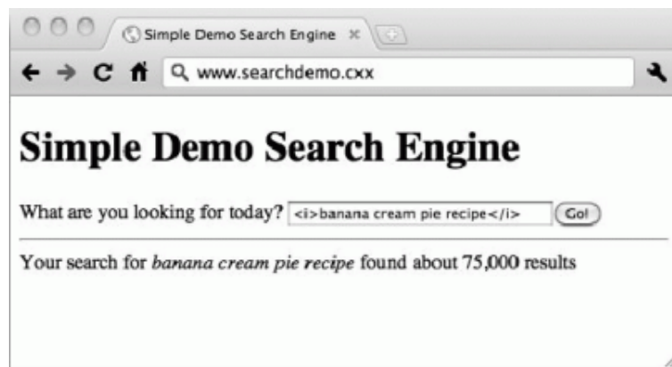
Slika 2.8: Primjer web tražilice s XSS propustom
