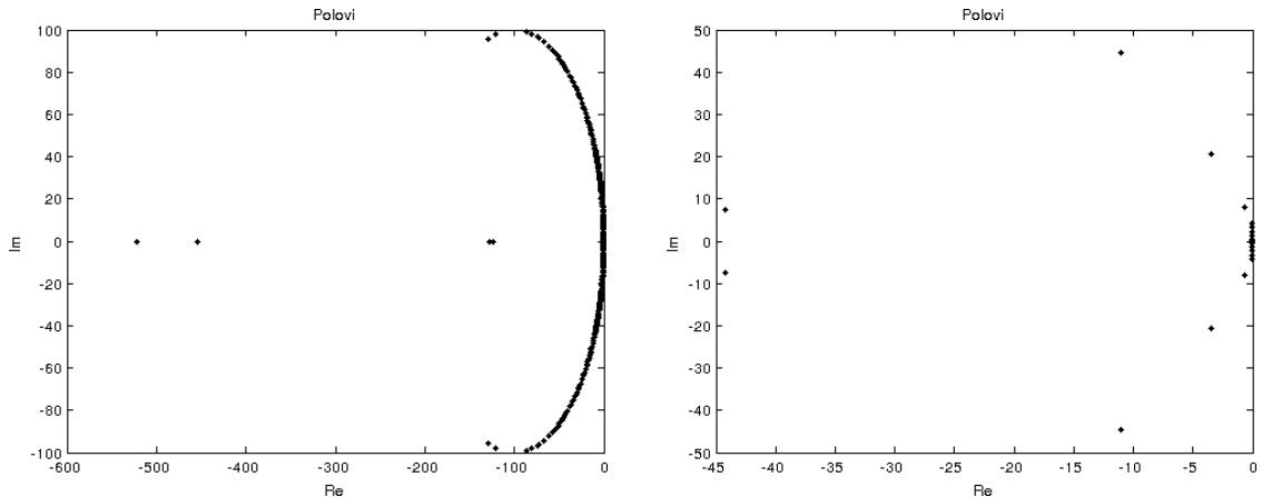
Slika 5.1: Polovi Beam modela iz NICONET baze [7] i reducirano modela reda  $r = 20$  dobivenog IRKA-om
