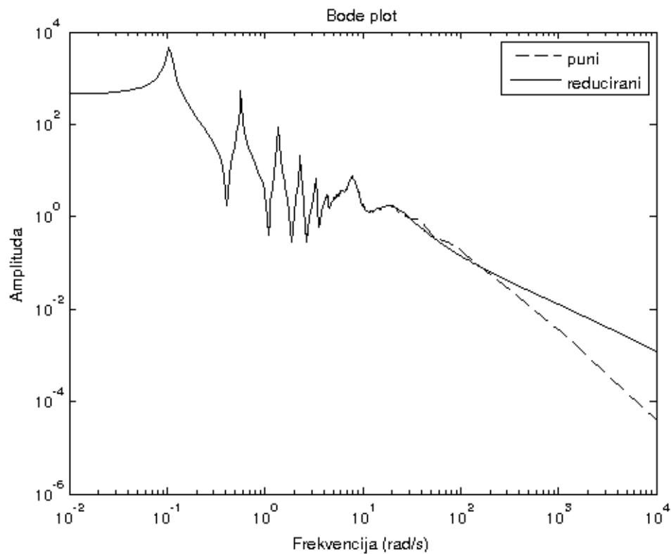
Slika 4.2: Bode plot Beam modela i reduciriranog modela reda  $r = 20$  dobivenom balansiranim rezanjem
