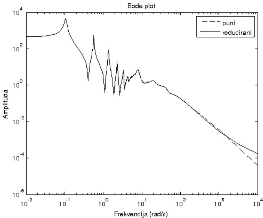
Slika 5.2: Bode plot Beam modela iz NICONET baze [7] i reducirano modela reda  $r = 20$  dobivenog IRKA-om
