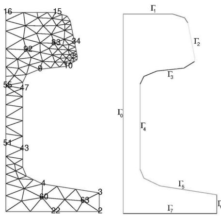
Slika 1.2: Polovica presjeka tračnice [1]: lijeva slika prikazuje triangulaciju domene, a desna podjelu ruba domene na osam krivulja
