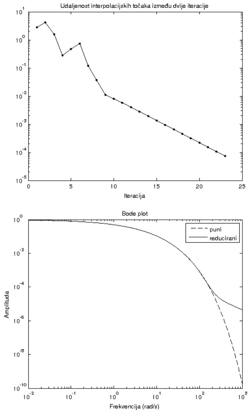
Slika 5.4: Udaljenosti uzastopnih interpolacijskih točaka i Bode plot punog i reduciriranog modela kod redukcije TF-IRKA-om na red  $r = 10$
