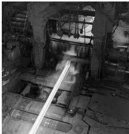
Slika 1.1: Proizvodnja čeličnih tračnica [1]
