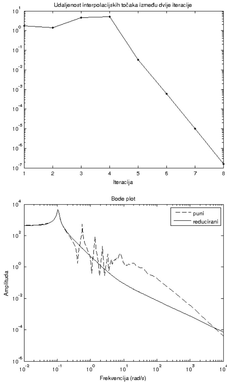
Slika 6.2: Udaljenosti uzastopnih interpolacijskih točaka i Bode plot punog i reduciranoj modela kod redukcije IRKA-om na red  $r = 2$
