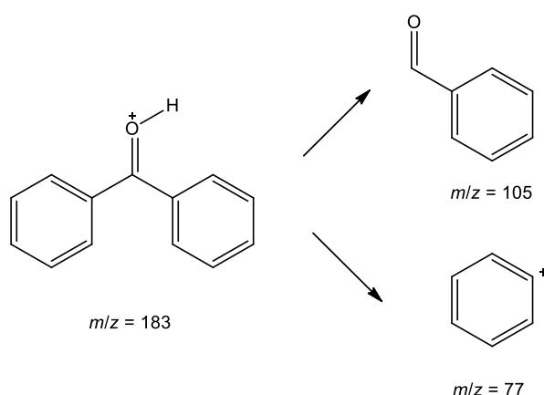
**Slika 4.15.** Predloženi mehanizam fragmentacije benzofenona (ESI+)**Tablica 4.13.** Molekulski ioni i fragmenti (ioni produkti) BPA i BFN
