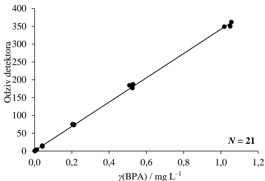
Slika 4.36. Ovisnost površine krivulje BPA o masenoj koncentraciji u standardnim otopinama pripravljenim u smjesi metanola i vode,  $N$  = ukupni broj mjerjenja.
