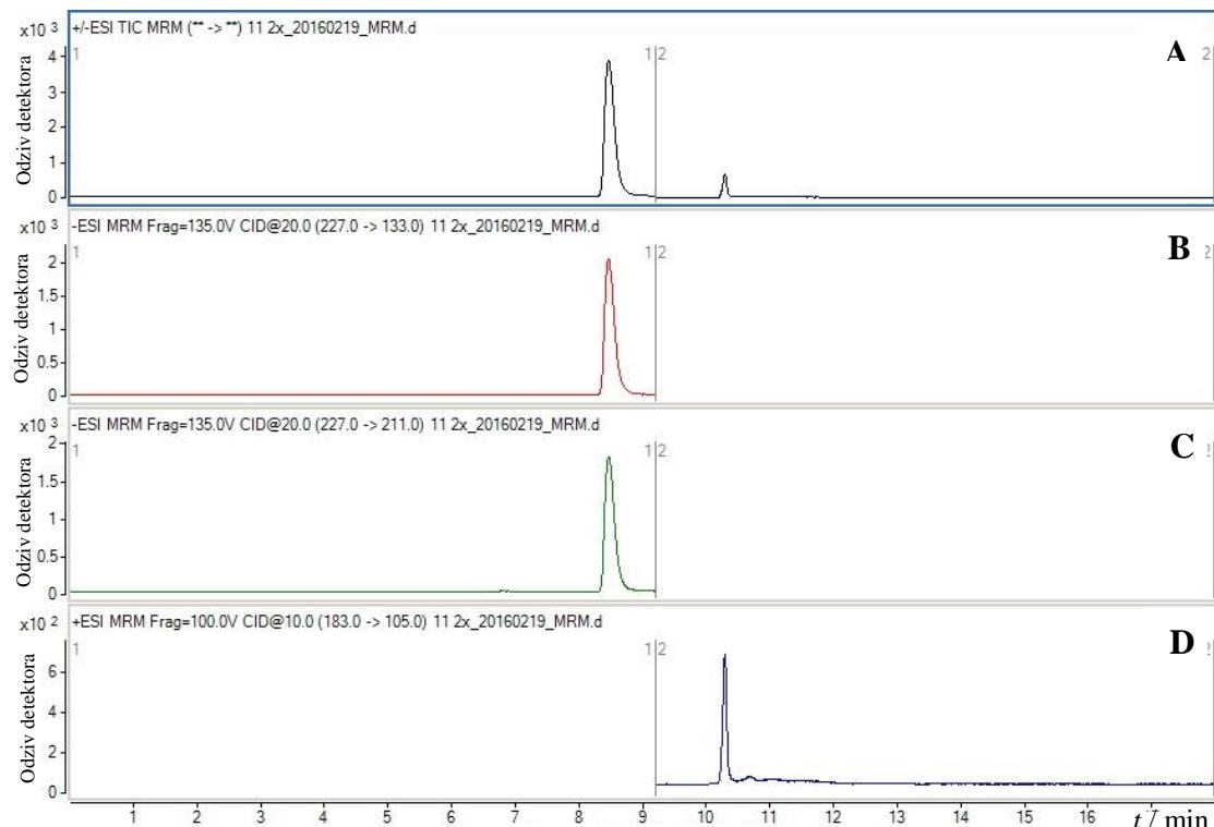
**Slika 4.16.** Kromatogram ukupne ionske struje uzorka 2.2. *Blue-cold*,  $\gamma(\text{BPA})_{\text{otopina}} = 42 \text{ mg L}^{-1}$ ,  $w(\text{BPA})_{\text{uzorak}} = 1,96 \%$ ;  $\gamma(\text{BFN})_{\text{otopina}} = 2 \text{ mg L}^{-1}$ ,  $w(\text{BFN})_{\text{uzorak}} = 0,34 \%$  (A). MRM kromatogram bisfenola A (B i C) i benzofenona (D). Uvjeti analize opisani su pod 3.6.6.  ${}^{1|2}$  prijelaz između negativne i pozitivne ionizacije.
