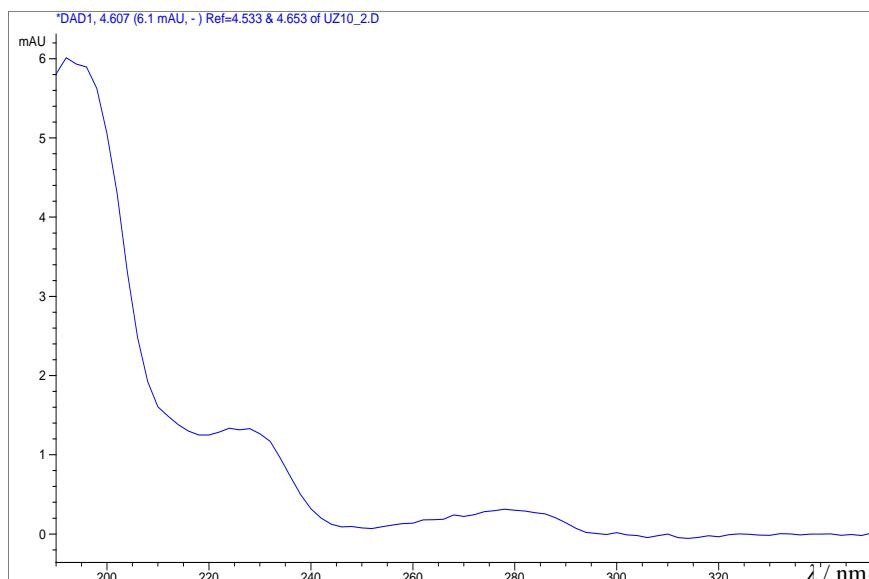
**Slika 4.35.** UV-apsorpcijski spektar bisfenola A ekstrahiranog iz uzorka gornjeg sloja tla u kojem je bio voluminozni papir 150 dana; pokretna faza: smjesa voda i acetonitrila [ $\varphi(\text{H}_2\text{O}) = 0,53$ ]
