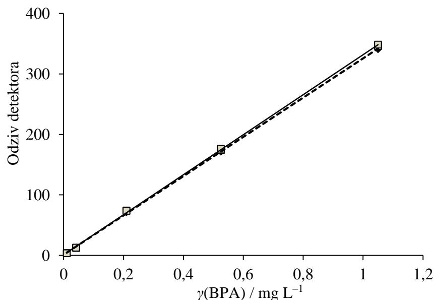
**Slika 4.32.** Ovisnost površine krivulje BPA o masenoj koncentraciji u standardnim otopinama pripravljenim u smjesi metanola i vode (ravna linija) i u ekstraktu tla (isprikidana linija)
