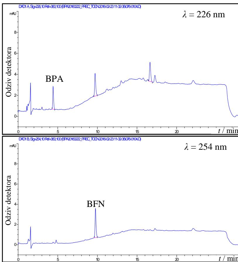
**Slika 4.10.** Kromatogrami uzorka termokromne boje 4.1. *Wet offset blue 45* °C kojem su dodani bisfenol A i benzofenon u masenom udjelu jednakom granici određivanja,  $\gamma(\text{BPA}) = \gamma(\text{BFN}) = 1 \text{ mg L}^{-1}$ .
