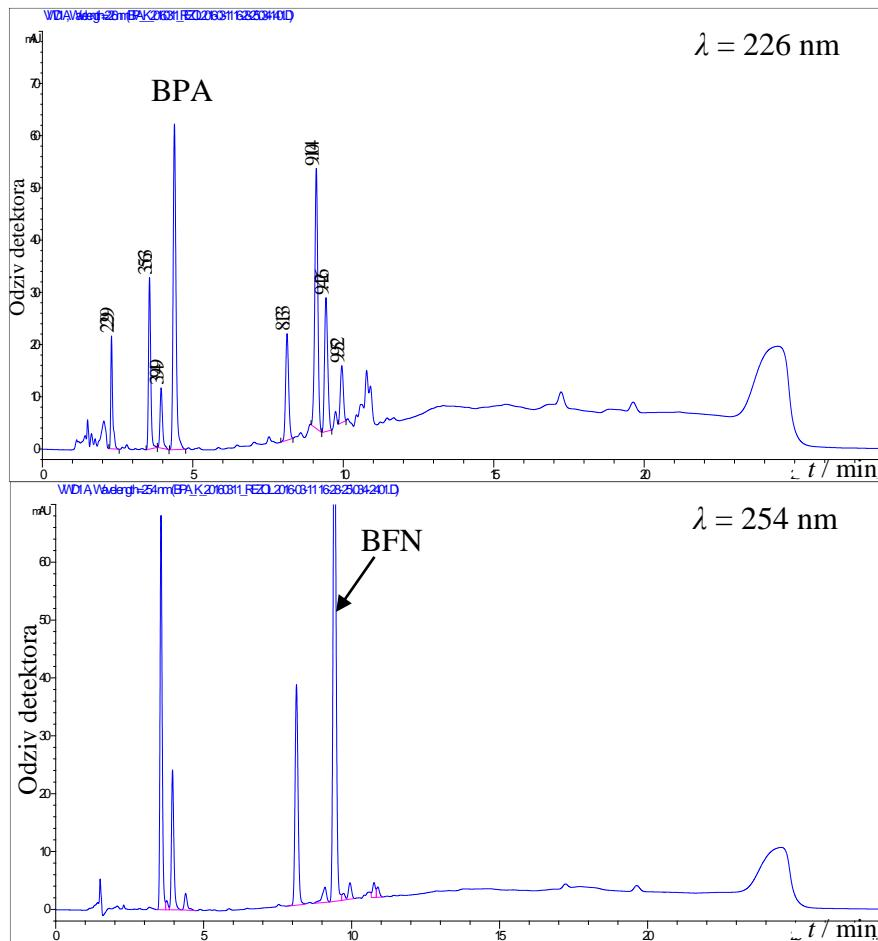
**Slika 4.7.** Kromatogrami uzorka 5.1. *UV purple to pink 31 °C* u koji je dodana standardna otopina BPA i BFN pri 226 nm i 254 nm.  $w(\text{BPA}) = 1,2 \%$ ,  $w(\text{BFN}) = 1,2 \%$
