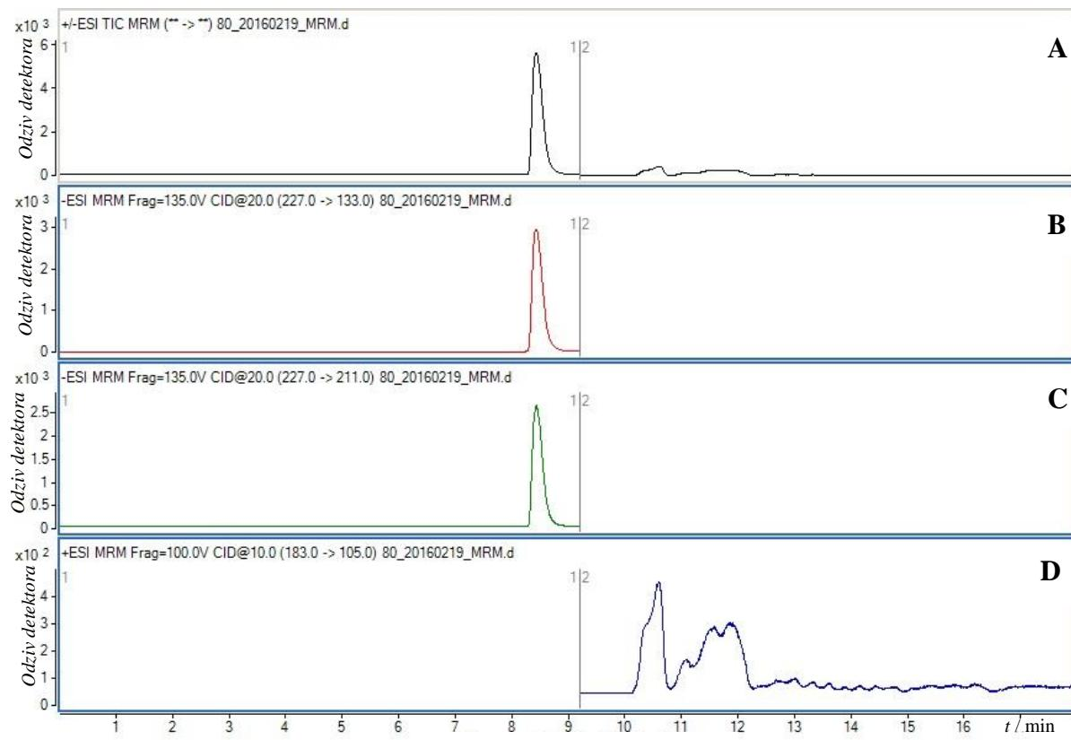
**Slika 8.11.** Kromatogram ukupne ionske struje otopine standarda bisfenola A i benzofenona u otopini uzorka 6.1. *Screen UV blue 31 °C*,  $\gamma(\text{BPA}) = 80 \text{ mg L}^{-1}$ ,  $\gamma(\text{BFN}) = 20 \text{ mg L}^{-1}$  (A). MRM kromatogram bisfenola A (B i C) i benzofenona (D). Uvjjeti analize opisani su pod 3.6.6.  ${}^{1|2}$  prijelaz između negativne i pozitivne ionizacije.
