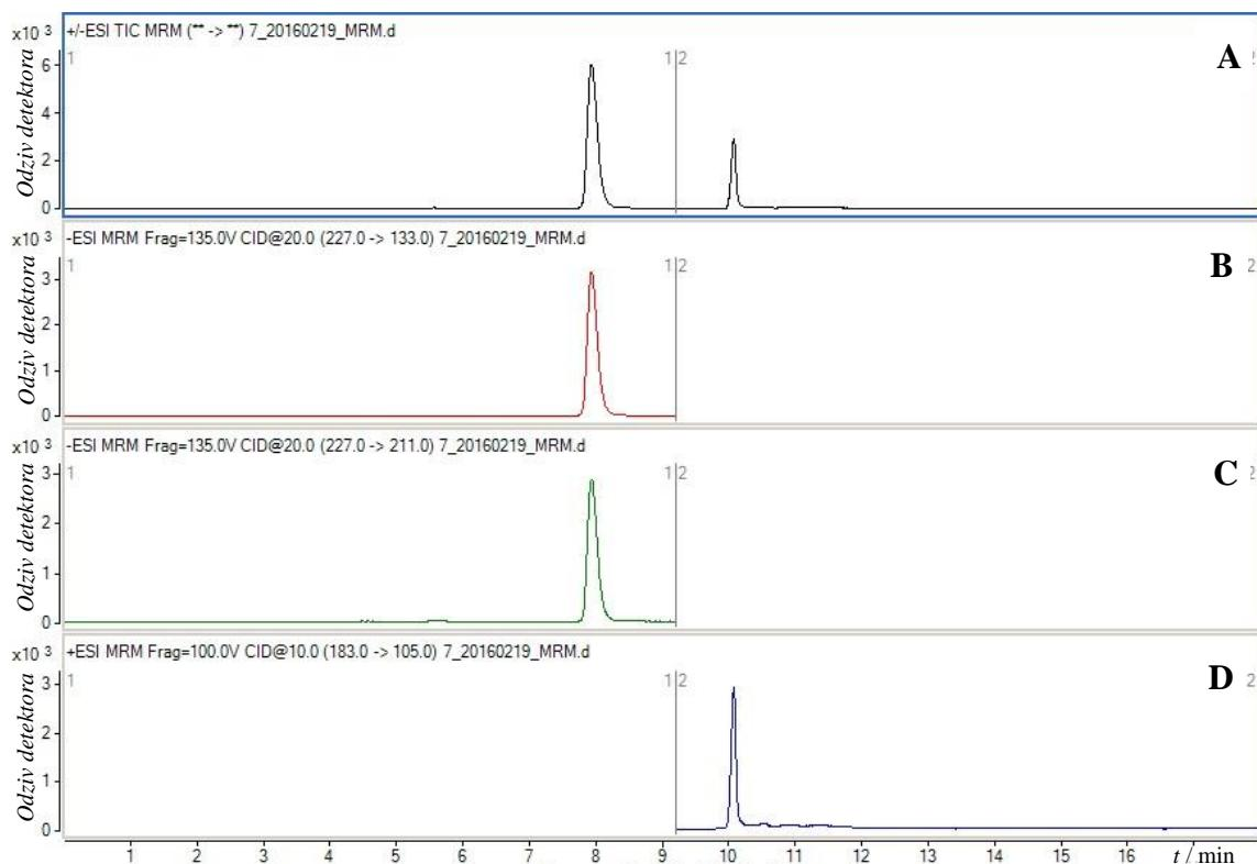
**Slika 8.10.** Kromatogram ukupne ionske struje uzorka 2.1. *Magenta room voda-UV*
