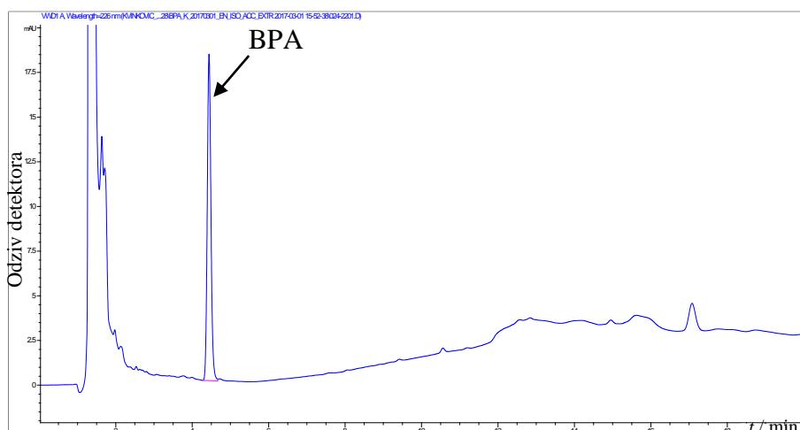
**Slika 4.21.** Kromatogram BPA ekstrahiranog iz uzorka papira *navigator* s termokromnim otiskom modelnom otopinom znoja pripravljenom prema normi EN 1811,  $w(\text{BPA}) = 0,167 \text{ mg g}^{-1}$
