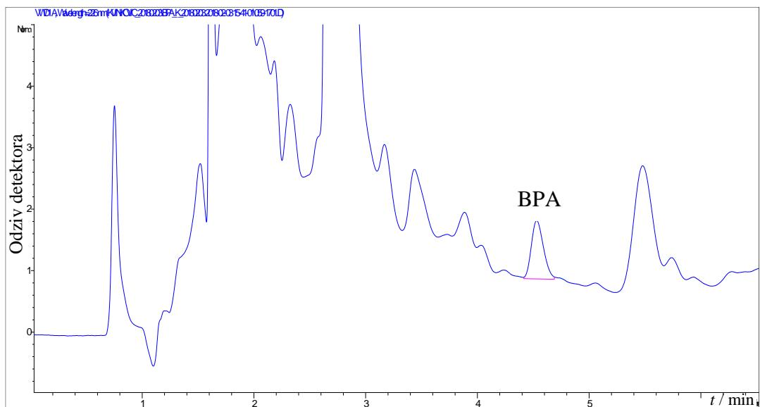
**Slika 4.34.** Uvećani dio kromatograma ekstrakta gornjeg sloja tla u kojem je bio voluminozni papir 150 dana,  $w(\text{BPA}) = 0,0152 \mu\text{g g}^{-1}$
