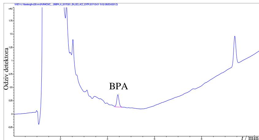
**Slika 4.29.** Uvećani dio kromatograma BPA ekstrahiranog iz uzorka papira modelnom otopinom znoja pripravljenom prema normi ISO 3160-2; masena koncentracija BPA dodanog otopini uzorka na granici određivanja:  $\gamma(\text{BPA}) = 0,0075 \text{ mg L}^{-1}$ ,  $w(\text{BPA}) = 0,0025 \text{ mg g}^{-1}$  ( $S/N = 13,3$ )
