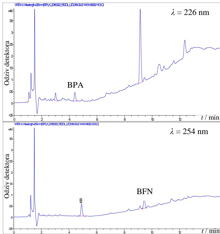
**Slika 4.11.** Kromatogrami uzorka termokromne boje 4.1. *Wet offset blue* 45 °C kojem su dodani bisfenol A i benzofenon u masenom udjelu jednakom granici detekcije,  $\gamma(\text{BPA}) = \gamma(\text{BFN}) = 0,1 \text{ mg L}^{-1}$ .
