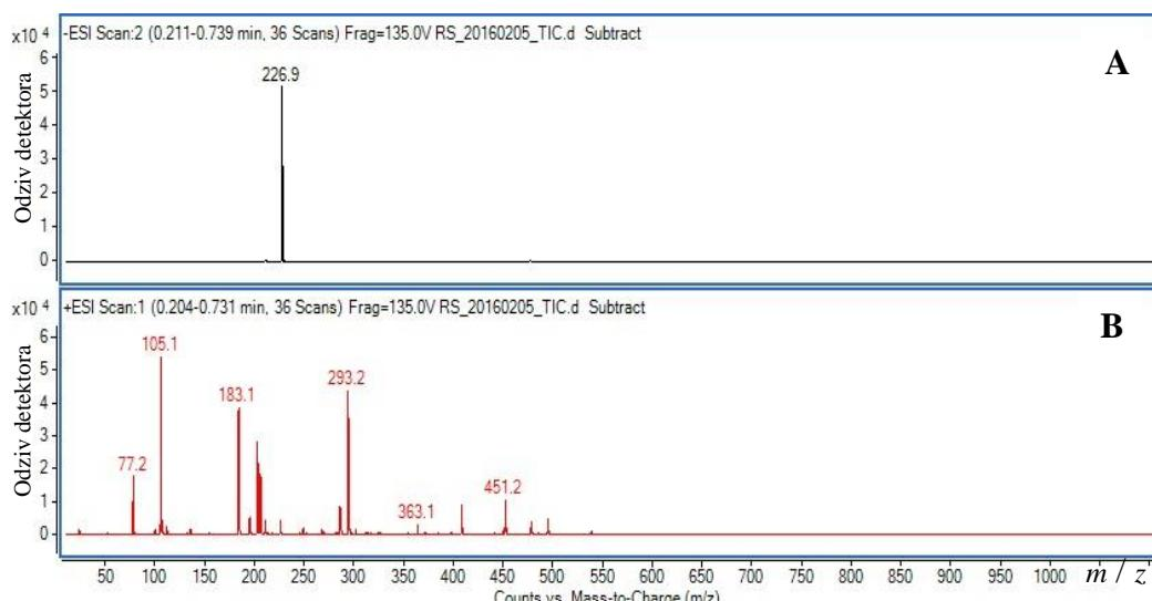
**Slika 4.12.** ESI-MS spektri otopine standarda BPA i BFN snimljeni uz negativnu (A) i pozitivnu (B) ionizaciju. Signali jednostruko nabijenih molekulskih iona uočeni su pri  $m/z = 226,9$  za bisfenola A te pri  $m/z = 183,1$  za benzofenon
