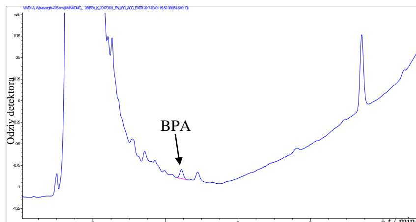
**Slika 4.28.** Uvećani dio kromatograma BPA ekstrahiranog iz uzorka papira modelnom otopinom znoja pripravljenom prema normi ISO 3160-2; masena koncentracija BPA dodana otopini uzorka na granici detekcije:  $\gamma(\text{BPA}) = 0,0025 \text{ mg L}^{-1}$ ,  $w(\text{BPA}) = 0,0008 \text{ mg g}^{-1}$  ( $S/N = 4,1$ )
