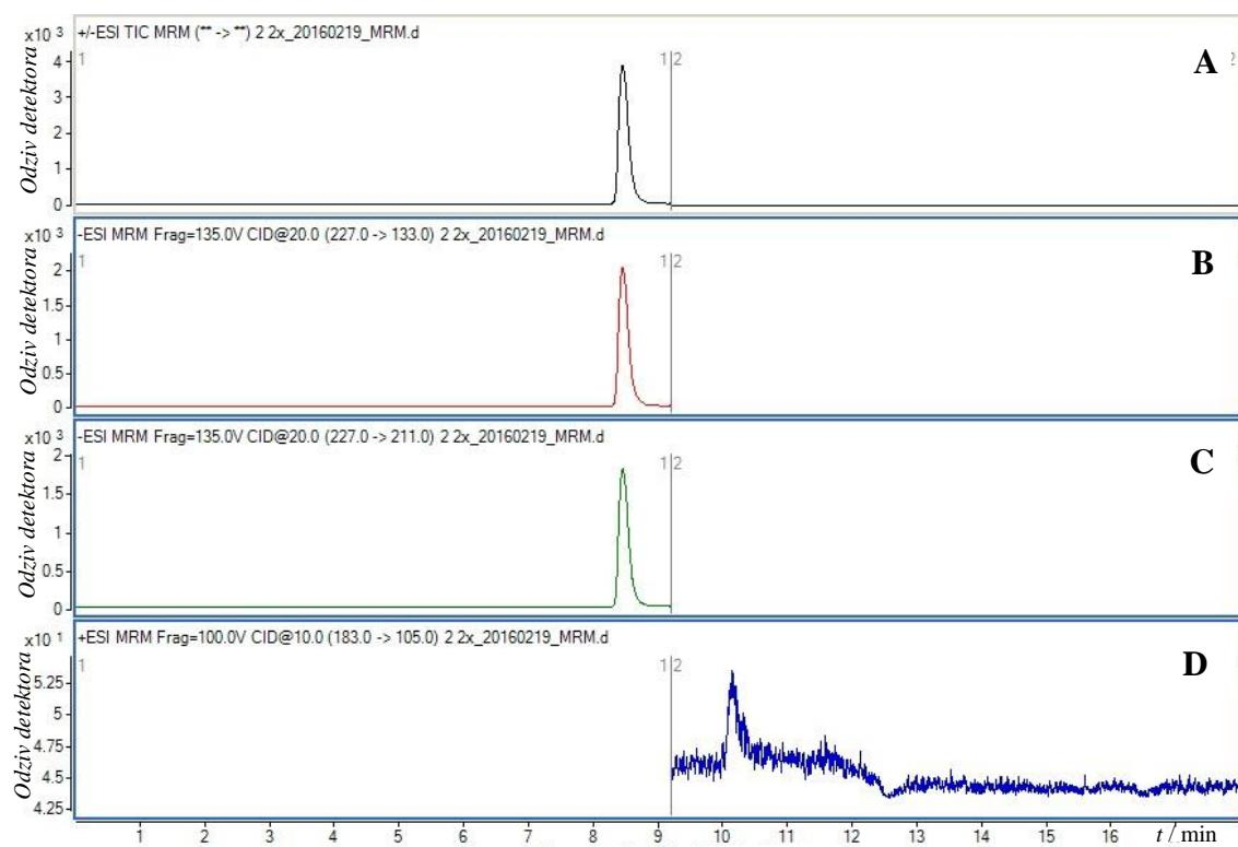
**Slika 8.9.** Kromatogram ukupne ionske struje uzorka 1.1. *Offset blue Chameleon 27 °C*  $\gamma(\text{BPA})_{\text{OT}} = 46 \text{ mg L}^{-1}$ ,  $w(\text{BPA})_{\text{uz}} = 1,95 \%$  (A). MRM kromatogram bisfenola A (B i C) i benzofenona (D). Uvjeti analize opisani su pod 3.6.6.  ${}^1|{}^2$  prijelaz između negativne i pozitivne ionizacije.
