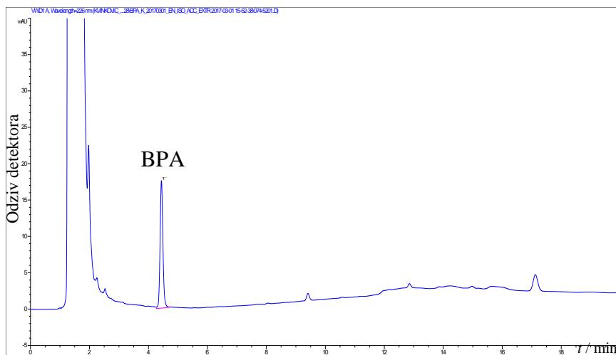
**Slika 4.22.** Kromarogram BPA ekstrahiranog iz uzorka papira *navigator* s termokromnim otiskom modelnom otopinom znoja pripravljenom prema normi ISO 3160-2,  $w(\text{BPA}) = 0,158 \text{ mg g}^{-1}$
