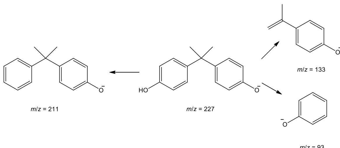
**Slika 4.14.** Pedloženi mehanizam fragmentacije bisfenola A (ESI-)
