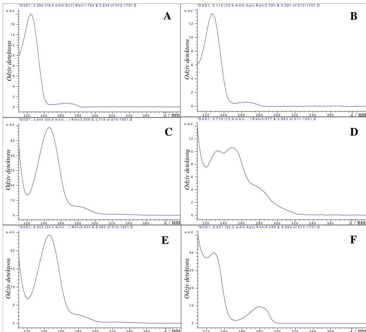
**Slika 8.7.** Apsorpcijski UV-spektri kromatografskih krivulja s vremenom zadržavanja
