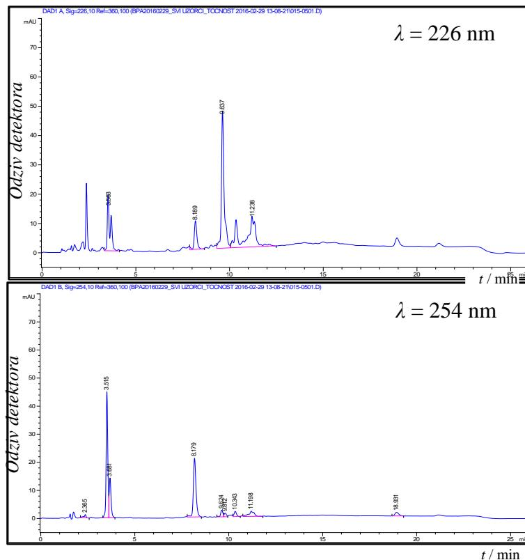
**Slika 8.4.** Kromatogrammi uzorka termokromne boje 5.2. *UV orange to yellow 12 °C* pri 226 i 254 nm
