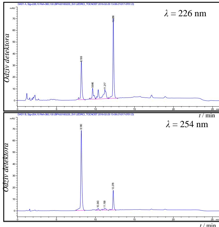
**Slika 8.5.** Kromatogrammi uzorka termokromne boje 6.1. *Screen UV blue 31 °C* pri 226 nm i 254 nm.
