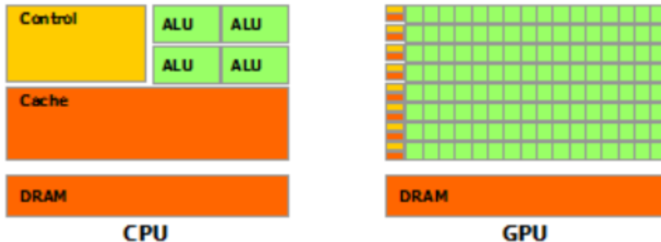
Slika 1.1: Raspored tranzistora na CPU i GPU
