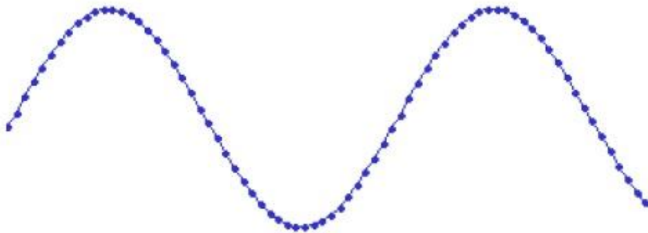
Slika 4. Val na kojem je svaka točka jedan audio uzorak
