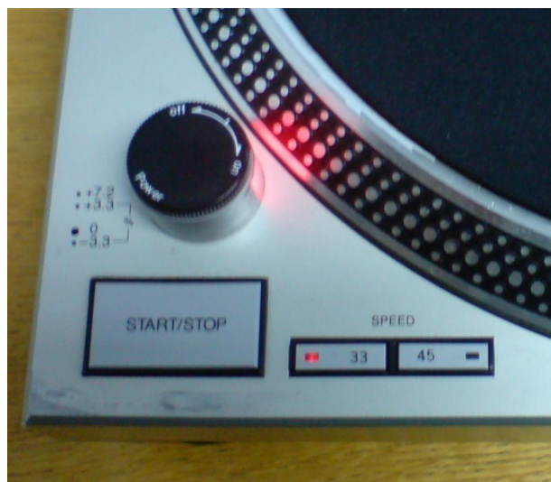
Slika 2.1: Stroboskopska lampica na gramofonu
