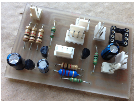
Slika 3.18: Gotova pločica (odozgo)
