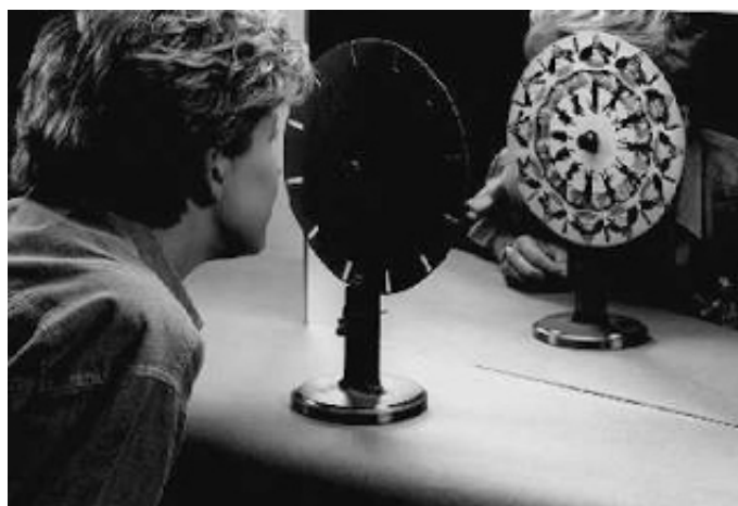
Slika 1.4: Početni izgled fenakistoskopa i Stampferovog stroboskopa
