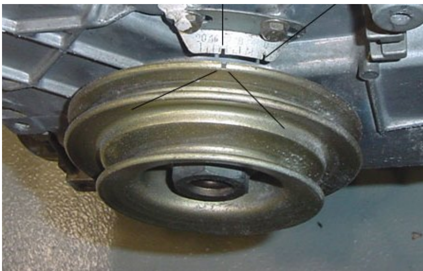
Slika 2.4: Remenice radilice s oznakom i pločica sa skalom za podešavanje kuta paljenja
