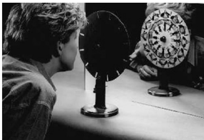
Slika 1.4: Početni izgled fenakistoskopa i Stampferovog stroboskopa
