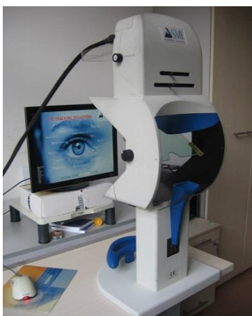
Slika 3.3: SMI iView X Hi-Speed uređaj za mjerenje pokreta očiju
