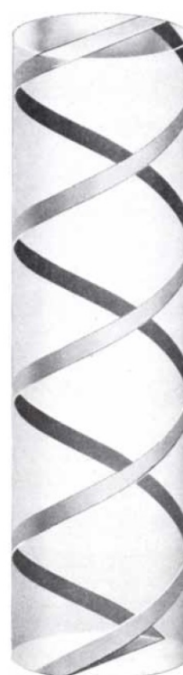
Slika 4.5: Rotacija vrha valjka obrnuto od kazaljke na satu oko središnje osi za dva puna okreta stvara desno-orijentiranu helikoidalnu vrpcu. Slika preuzeta iz [13].
