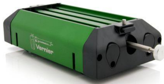
Slika 7.4: Kolica s elastičnim klipom. Preuzeto iz [11].
