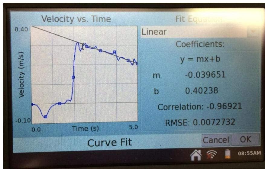
Slika 2.10: Određivanje akceleracije za treće mjerjenje
