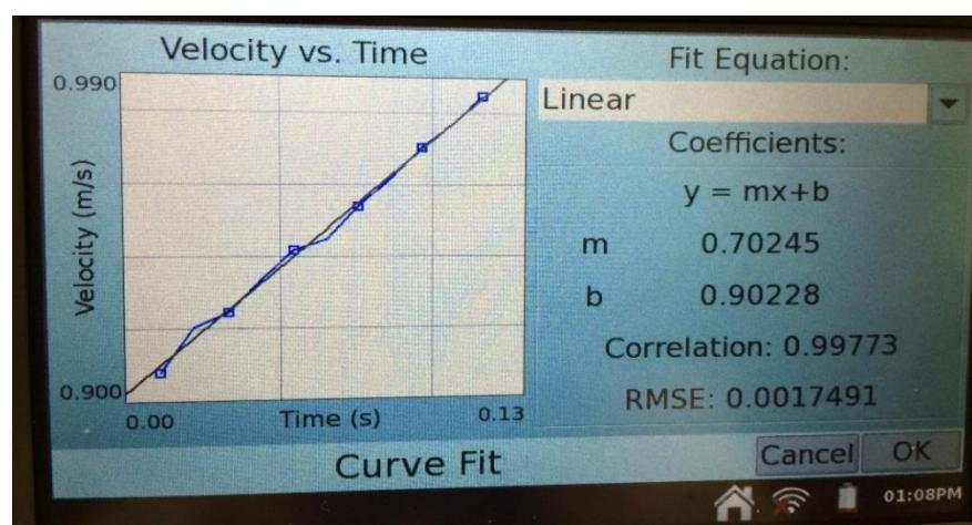
Slika 2.25: Izračunat nagib pravca za četvrto mjerjenje
