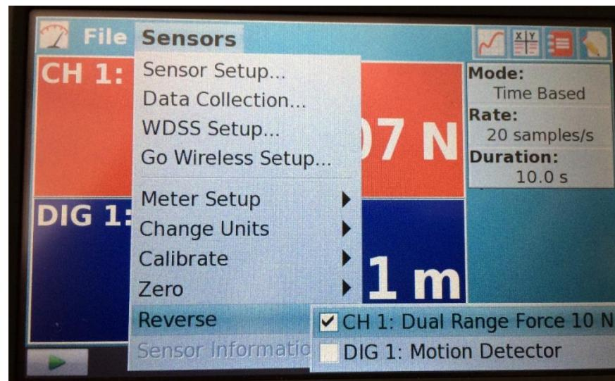
Slika 4.12: Prikaz okretanja pozitivnog smjera mjerena sile na računalu
