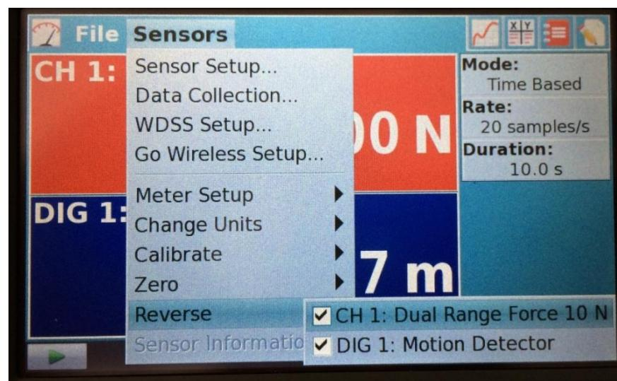
Slika 4.13: Prikaz okretanja pozitivnih smjerova mjerena sile i položaja na računalu
