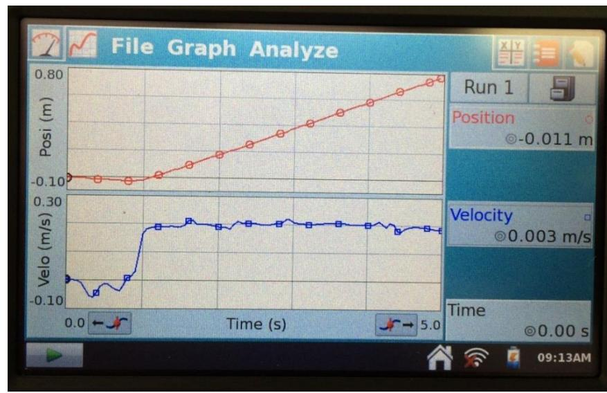
Slika 2.13: Prikaz sučelja za mjerjenje bez podloge za trenje
