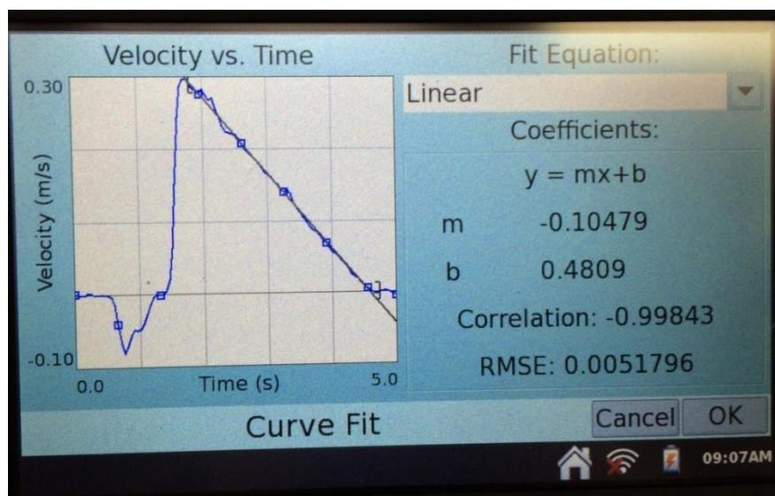
Slika 2.8: Određivanje akceleracije za drugo mjerjenje
