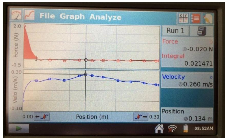
Slika 4.21: Prikaz izračunatog rada elastične sile za oprugu konstante elastičnosti 1
