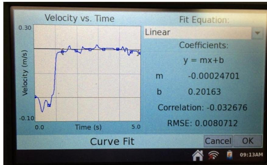
Slika 2.14: Određivanje akceleracije za mjerjenje bez trenja
