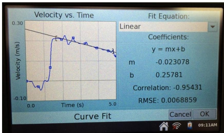
Slika 2.12: Određivanje akceleracije za četvrto mjerjenje
