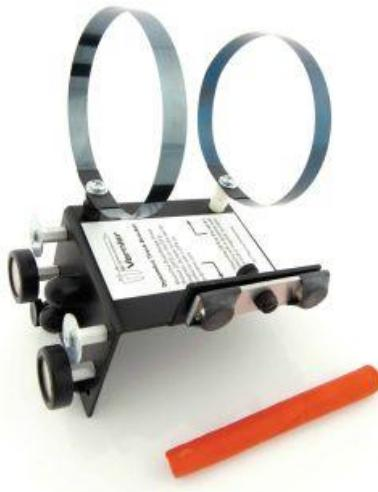
Slika 7.11: *Odbojnik i uređaj za lansiranje.* Preuzeto iz [11].
