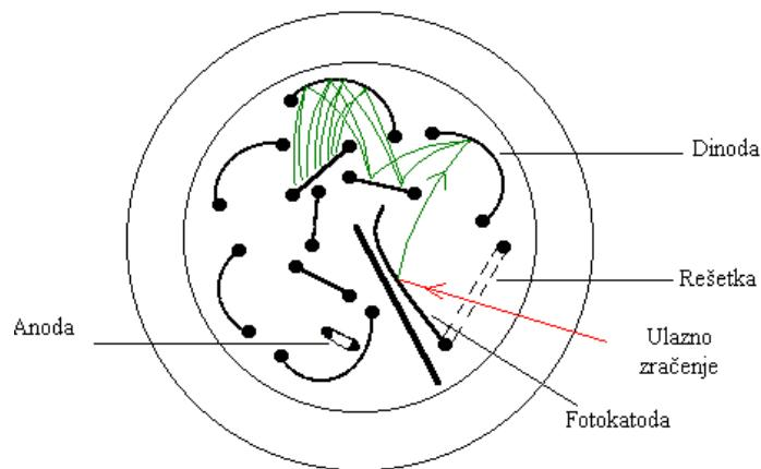
Slika 29b: Fotomultiplikator “kružnog” “dizajna” “side-on” koji smanjuje dimenzije, kao i put od katode do prve dinode (što smanjuje osjetljivost na vanjska magnetska polja), preuzeto iz [21]
