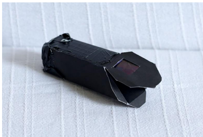
Slika 43: Spektrometar nakon sastavljanja – stražnja strana
