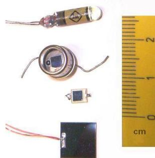
Slika 32: Nekoliko tipičnih fotodioda, preuzeto sa [24]
