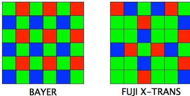
Slika 37: Usporedba klasičnog Bayerovog sa Fujijevim X-Trans filterom, preuzeto sa [30]
