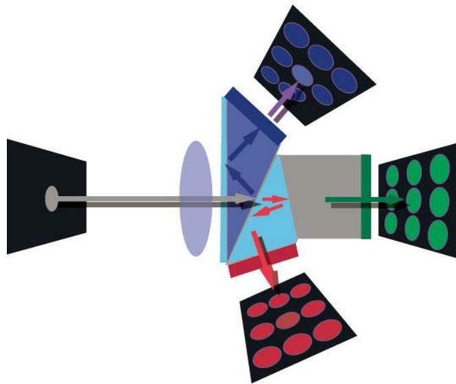
Slika 36: Princip rada 3CCD senzora, preuzeto sa [29]
