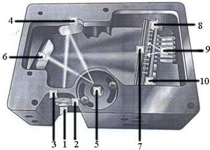
Slika 21: Shematski prikaz korištenog spektrometra, preuzeto iz [18]
