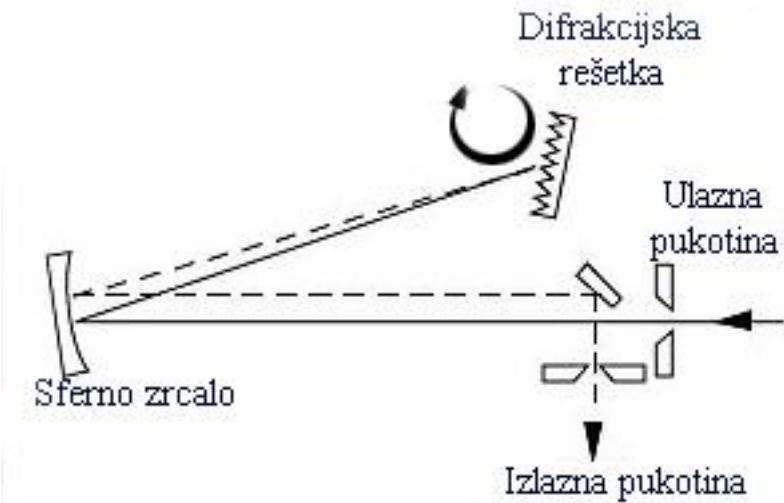
Slika 20: Spektrometar tipa Littrow, preuzeto sa [17]
