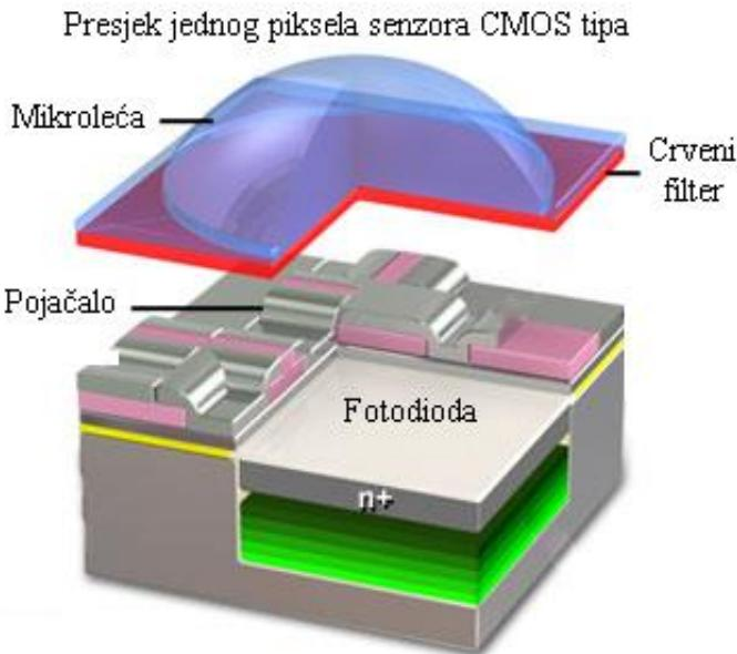
Slika 38: Presjek tipičnog piksela CMOS senzora, preuzeto sa [31]
