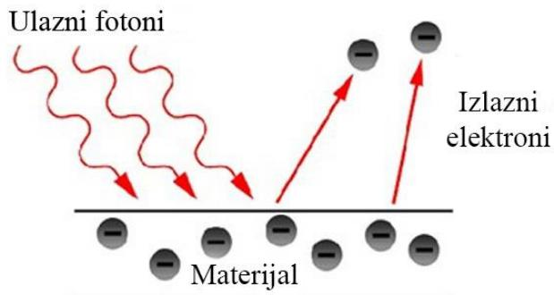
Slika 3: Fotoelektrični efekt, slika preuzeta sa [4]
