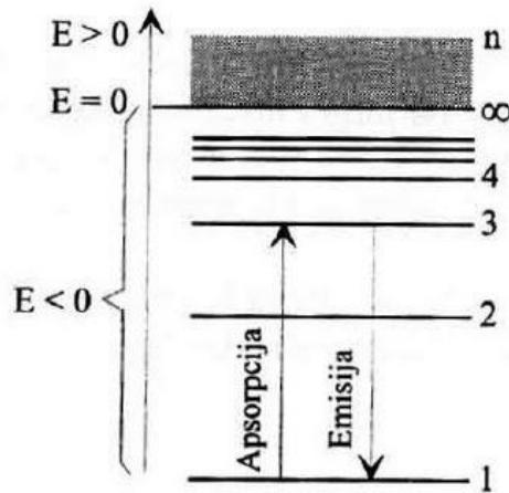
Slika 8: Dijagram energetskih nivoa u atomu vodika, prema Bohru, preuzeto iz [5]
