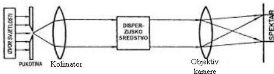
Slika 16: shema optičkog spektrograфа, preuzeto iz [5]
