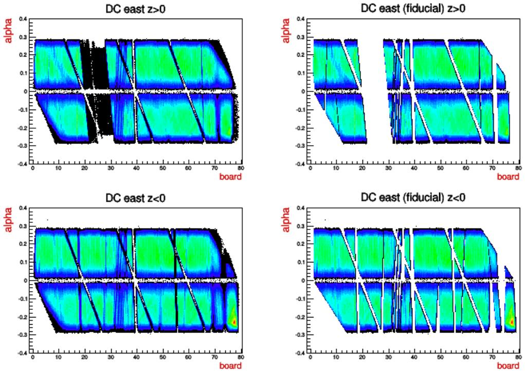
Slika 3.1: Prikaz sjevernog ( $zed > 0$ , na slici gore) i južnog ( $zed < 0$ , na slici dolje) dijela istočne komore prije (lijevo) i nakon (desno) uklanjanja neaktivnih ili nefunkcionalnih područja DC detektora.
