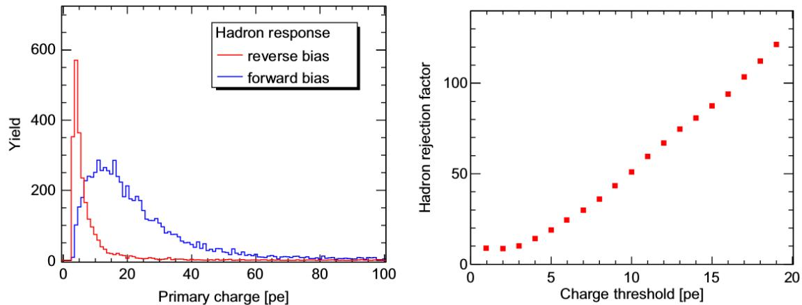
Slika 2.12: Odaziv HBD-a na hadrone u FB i RB načinu rada u p+p sudarima na 200 GeV u Run-9 (lijevo), uz prikaz faktora odbacivanja hadrona za postavljeni minimalni naboj na izlaznim heksagonalnim celijama (desno). Preuzeto iz [7].
