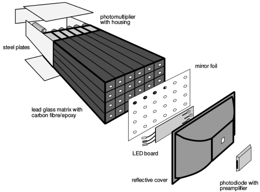
Slika 2.7: Shematski prikaz jednog supermodula PbGl detektora, sastavljenog od  $6 \times 4$  modula. Preuzeto iz [13].
