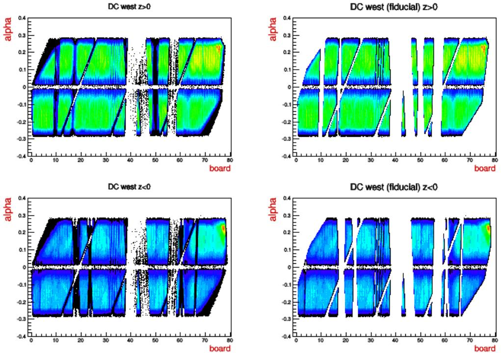
Slika 3.2: Prikaz sjevernog ( $zed > 0$ , na slici gore) i južnog ( $zed < 0$ , na slici dolje) dijela zapadne komore prije (lijevo) i nakon (desno) uklanjanja neaktivnih ili nefunkcionalnih područja DC detektora.
