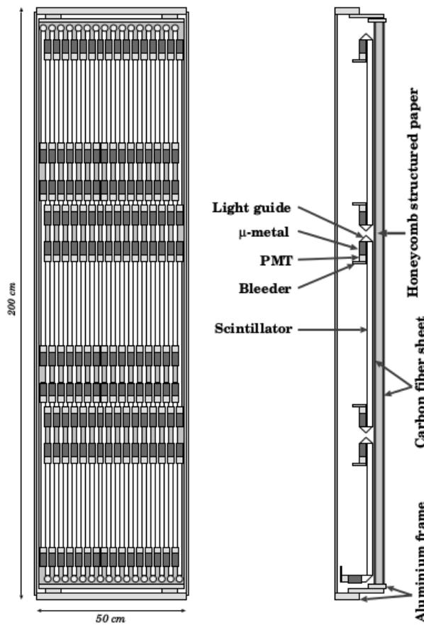
Slika 2.8: Shematski prikaz jedne ploče TOFE detektora. Preuzeto iz [12].
