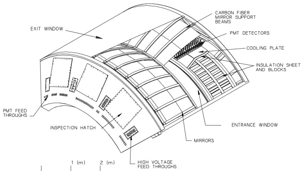
Slika 2.5: Shematski prikaz PHENIX-ovog RICH detektora. Preuzeto iz [12].
