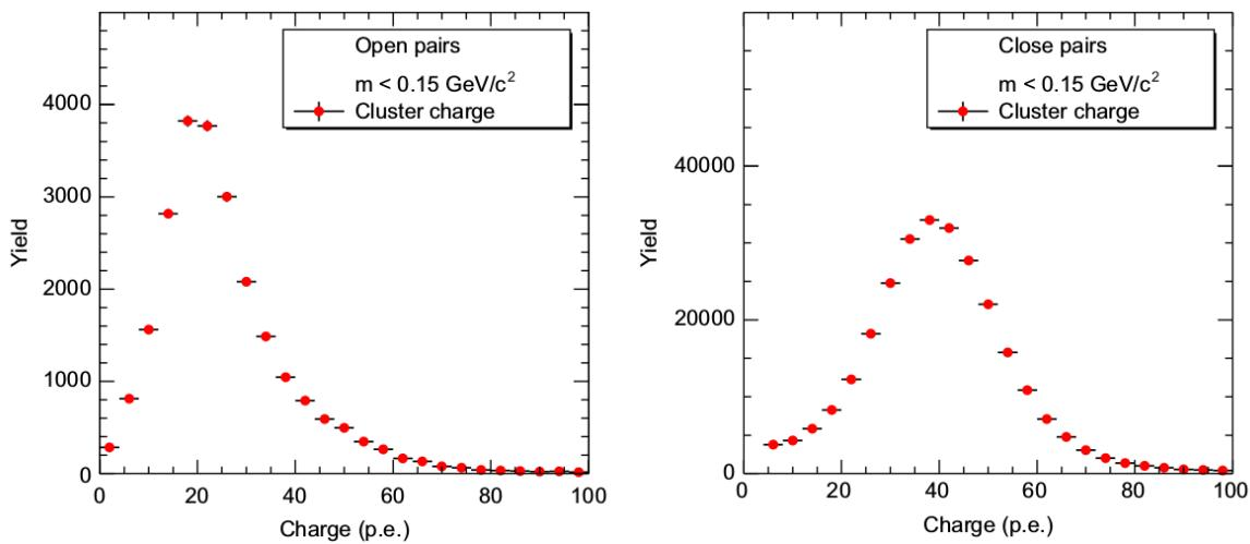
Slika 2.13: Odaziv HBD-a na jednostrukе i dvostrukе udare čestica u detektor u  $p+p$  sudarima na 200 GeV u Run-9. Za testni uzorak elektrona (pozitrona) su se koristile trajektorije iz područja invarijantne mase  $m_{ee} < 0.15 \text{ GeV}/c^2$ , gdje je kombinatorijska pozadina zanemariva. Preuzeto iz [7].
