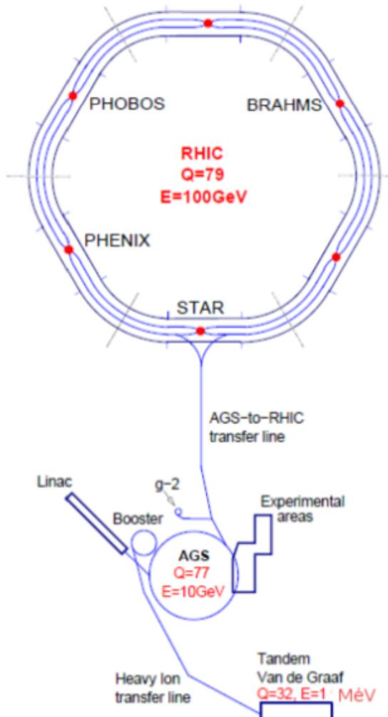
Slika 2.1: Prikaz RHIC-ovog akceleratorskog kompleksa na BNL-u i puta kojem sno-povi iona zlata prođu do sudara u PHENIX ili STAR detektoru.
