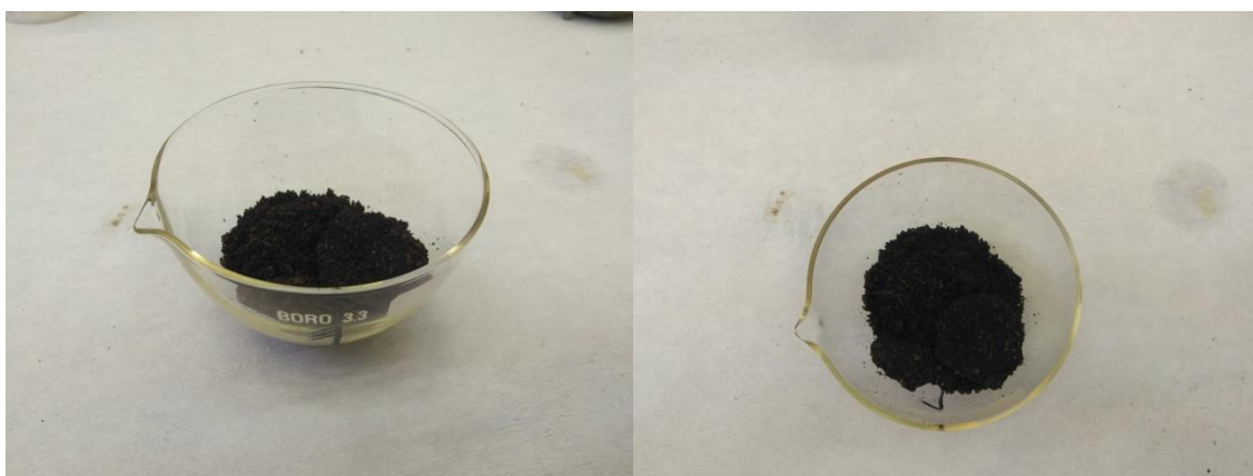
Slika 7: Geopolimer 1 nakon sušenja u labaratorijskoj pećnici 24 h
