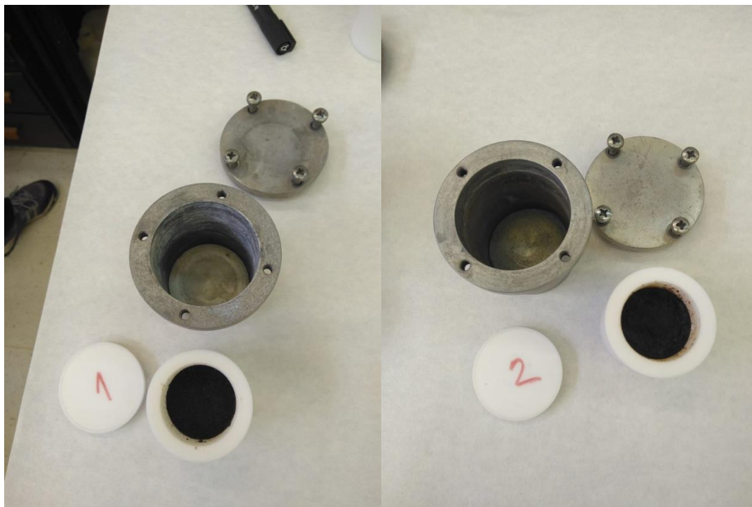
Slika 6: Priprema za sušenje pripremljenih geopolimera 1 (lijevo) i 2 (desno) u labaratorijskoj pećnici 24 h
