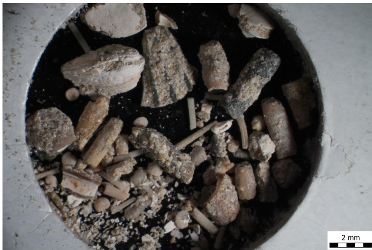
Slika 11. Najčešći fosili iz uzorka broj 7, izdvojeni tehnikom muljenja (mokrog prosijavanja)
