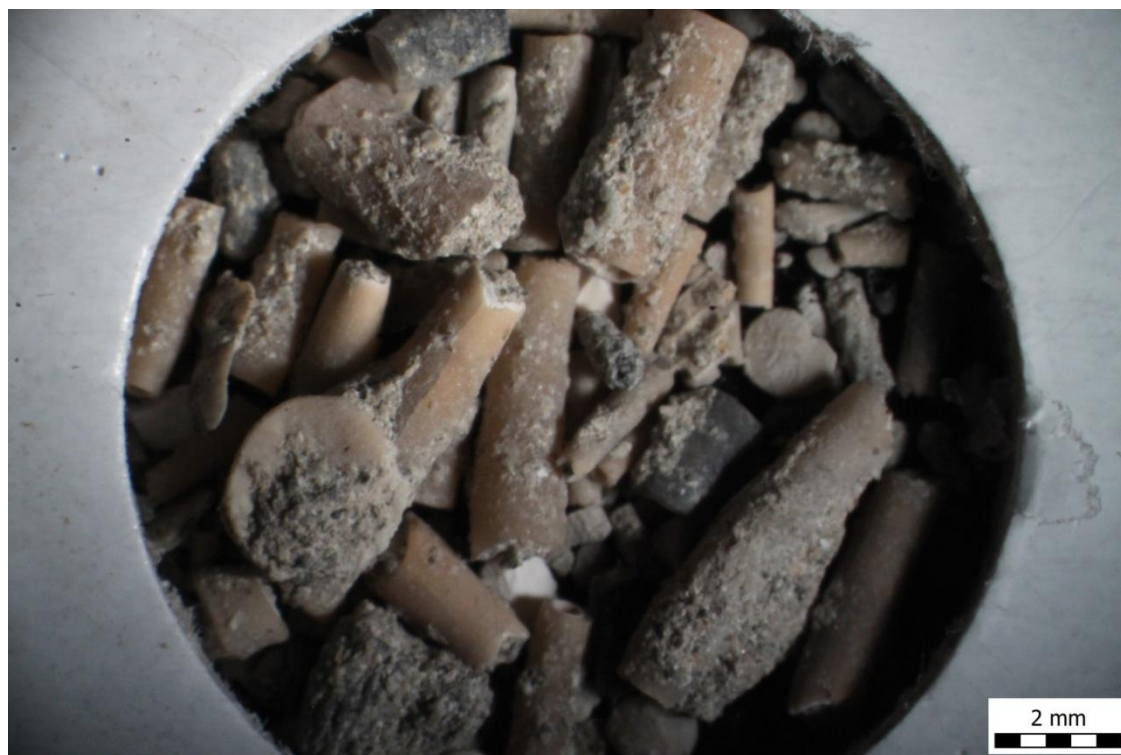
Slika 6. Najčešći fosili iz uzorka broj 2, izdvojeni tehnikom muljenja (mokrog prosijavanja)
