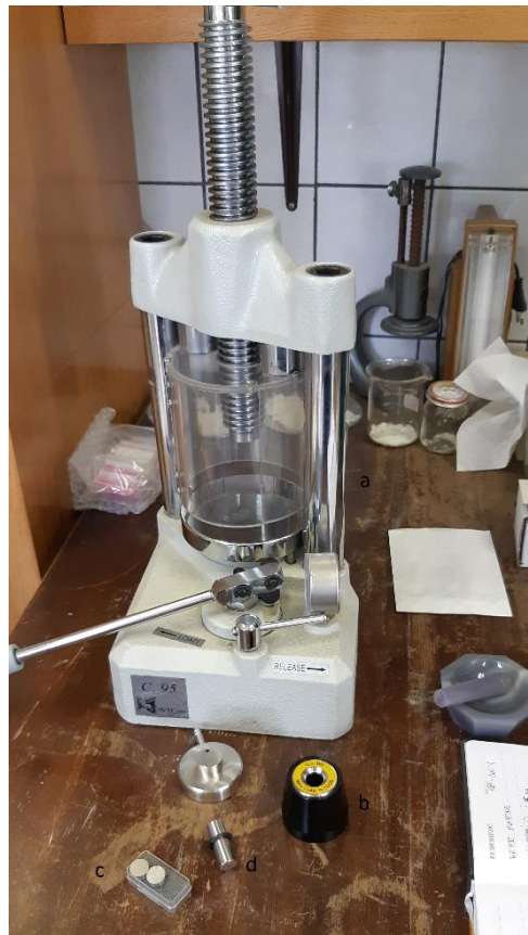
Slika 3.7. a) preša, b) nosač za prešu, c) pločice za nosač, d) cilindar
