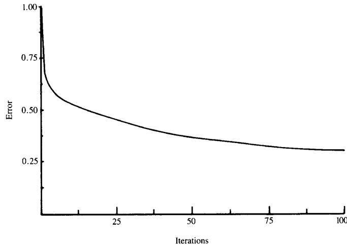
Slika 3.5: Jacobijeva metoda s inicijalnom vrijednošću  $\frac{1}{3}[\sin\left(\frac{j\pi}{N}\right) + \sin\left(\frac{6j\pi}{N}\right) + \sin\left(\frac{32j\pi}{N}\right)]$ .
