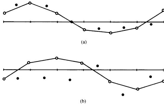
Slika 3.8: (a) Ako je egzaktna greška na  $\Omega^h$  (označena sa  $\circ$  i  $\bullet$ ) glatka, interpolant aproksimacije grUBLje mreže  $e^{2h}$  (označen sa  $\circ$ ) bi trebao dati dobru reprezentaciju egzaktne pogreške. (b) Ako je egzaktna greška na  $\Omega^h$  (označena sa  $\circ$  i  $\bullet$ ) oscilacijska, interpolant aproksimacije grUBLje mreže  $e^{2h}$  (označen sa  $\circ$ ) bi mogao dati lošu reprezentaciju egzaktne pogreške.
