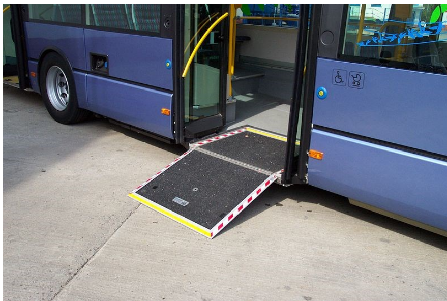
Sl. 4. Primjer rampe za ulazak u autobus osobama koje se kreću uz pomoć kolica
