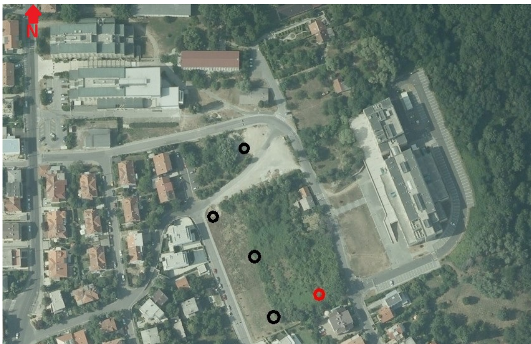
Slika 4.6: Satelitska snimka područja Zagrebačke terase i okolici zgrade BGG s označenim položajem bušotina. Crvenom bojom označena je bušotina čija je jezgra opisana do dubine od 44 m (T. Marjanac, 2018).
