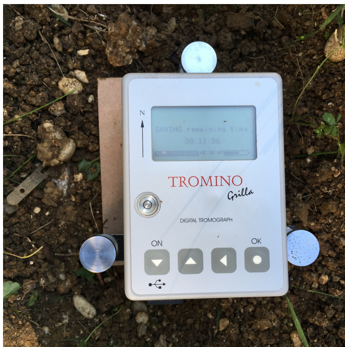
Slika 5.1: Tromino, uređaj za mjerenje seizmičkog nemira
