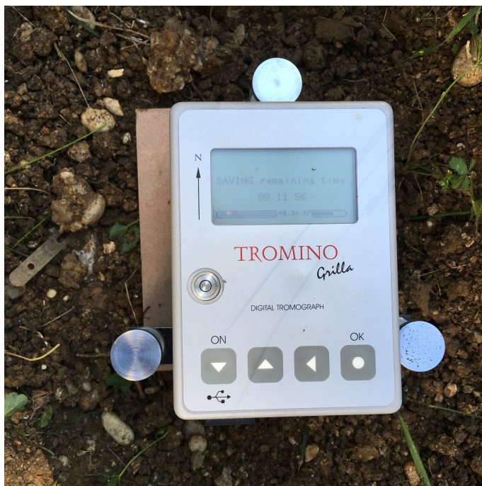
Slika 5.1: Tromino, uređaj za mjerenje seizmičkog nemira
