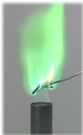
Slika M23. Beilsteinova proba. 19
