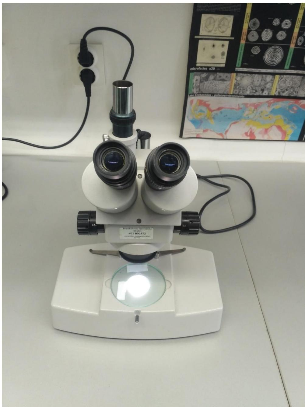
Slika 8. Svjetlosna lupa Stereo Zoom Microscope XTL.
