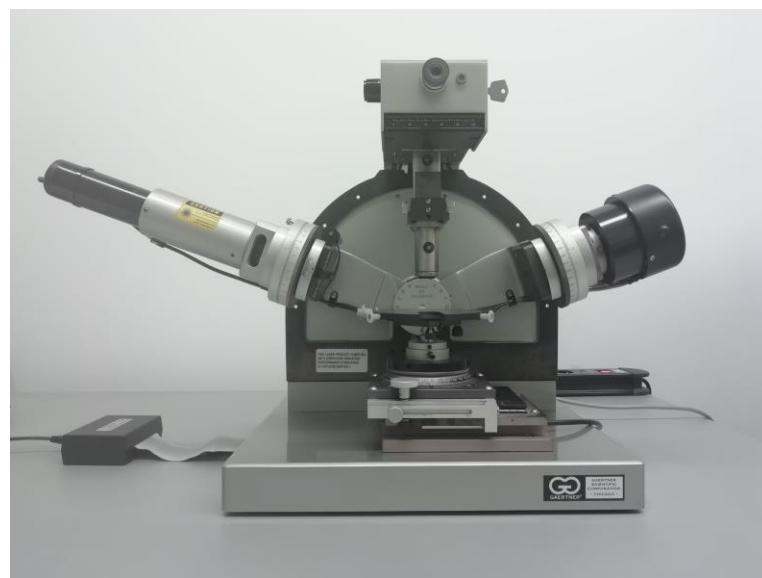
Slika 14. Elipsometar L116B
