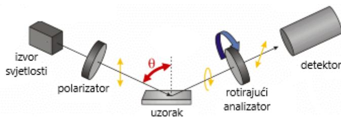
**Slika 12.** Shematski prikaz elipsometra s rotirajućim analizatorom (RAE)<sup>32</sup>
