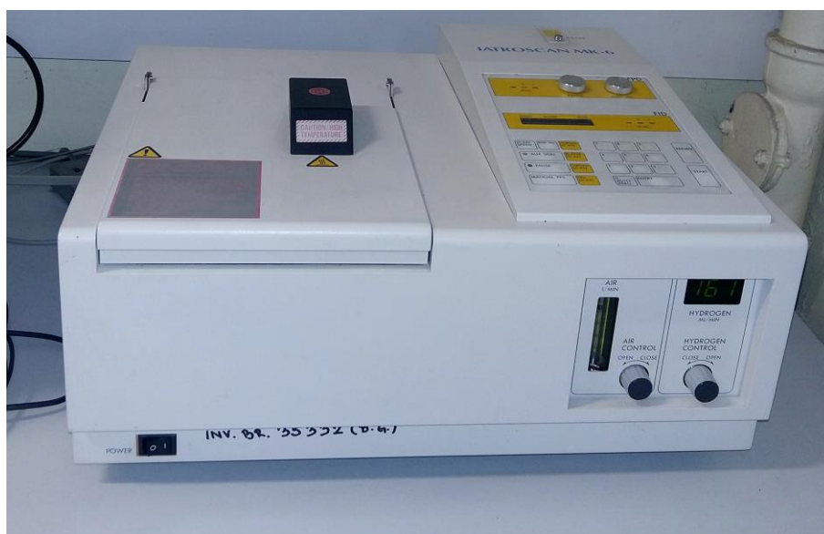
Slika 14. Instrument za analizu lipida, IATROSCAN MK-6
