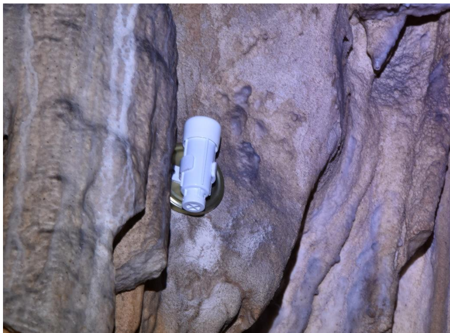
Slika 7. Memorijski termohigrograf postavljen na zid špilje
