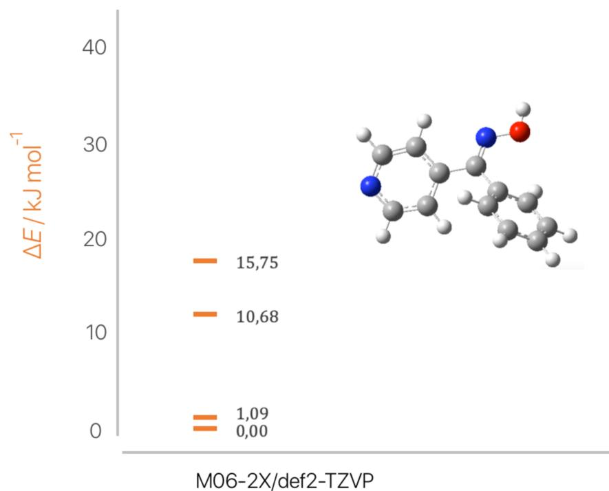
Slika 31. Relativne energije konformera liganda **4-phoxypy** optimizirane na M06-2X/def2-TZVP razini teorije. Prikazana je geometrija najstabilnijeg konformera.
