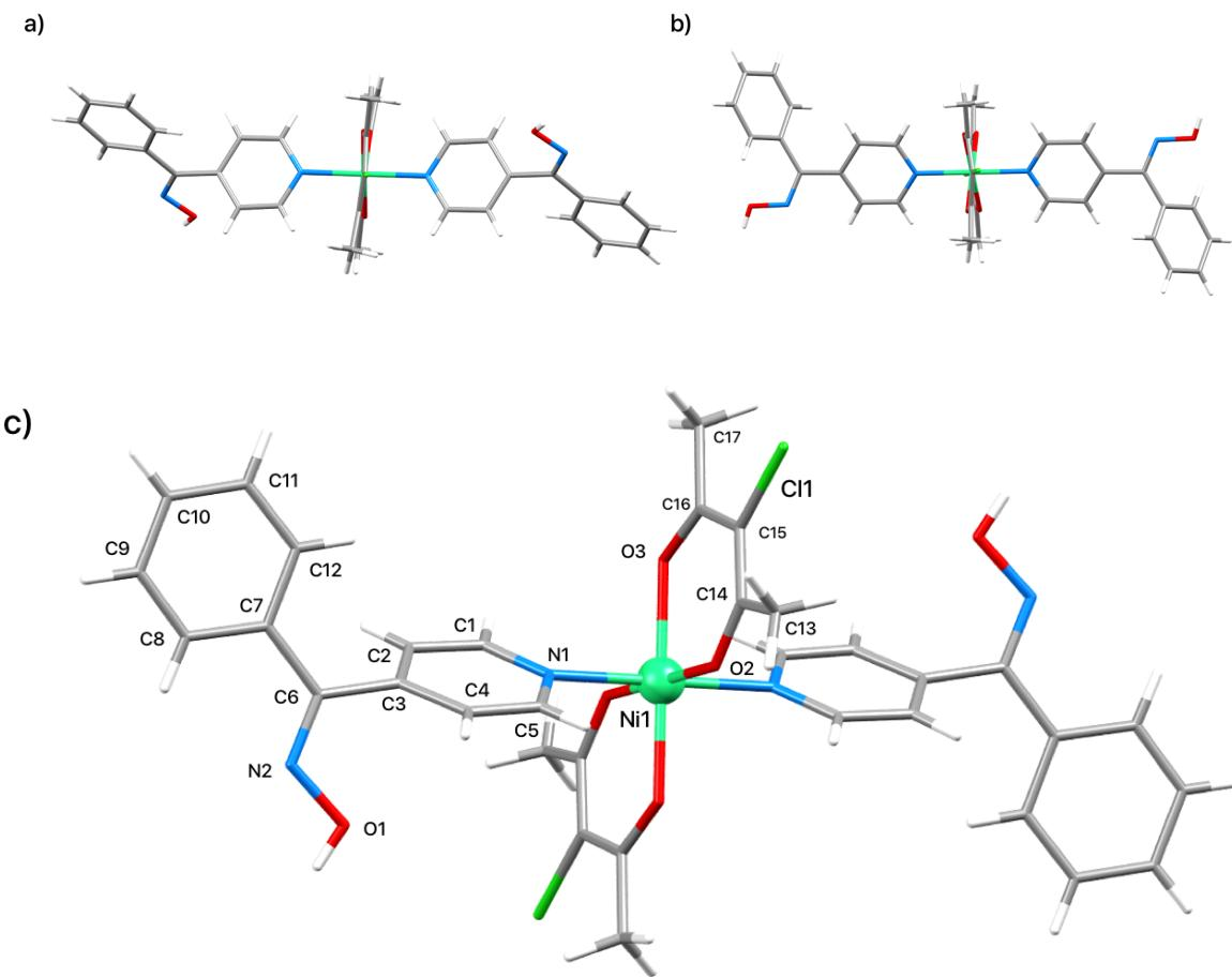
Slika 19. a) Molekulska struktura 5a-I; b) molekulska struktura 5a-II; c)  $[Ni(Cl\text{-}acac)}_2(4\text{-phoxpy})_2]$  sa shemom numeracije (5a-I).
