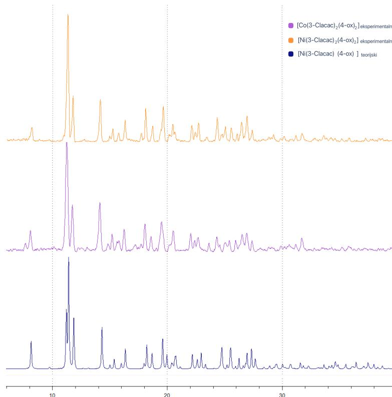
**D8.** Difraktogram polikristalnih uzorka sustava sa **4-oxy** kao ligandom.  $[\text{Co}(3\text{-Cl-acac})_2(4\text{-oxo})_2]$ , označen ljubičastom bojom, priređen je mehanokemijskom sintezom, dok je  $[\text{Ni}(3\text{-Cl-acac})_2(4\text{-oxo})_2]$  (**4a**), priređen otopinskom sintezom. Tamnoplavom bojom označen je teorijski generiran difraktogram  $[\text{Ni}(3\text{-Cl-acac})_2(4\text{-oxo})_2]$ .
