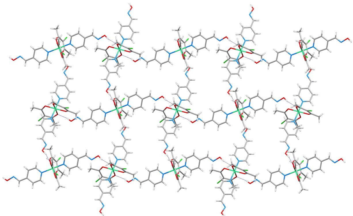
Slika 18. 2-D supramolekulska arhitektura  $[\text{Ni}(\text{Cl}-\text{acac})_2(4-\text{oxy})_2]$ .
