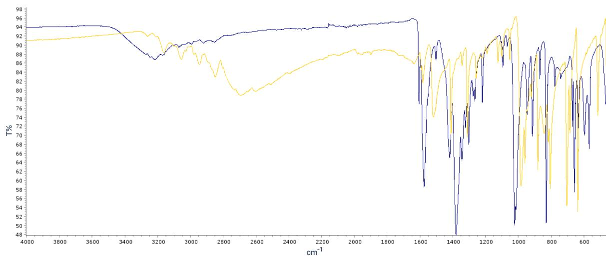
**D11.** IR spektar  $[\text{Ni}(\text{Cl-acac})_2(3\text{-oxypy})_2]$  (tamnoplavo) i liganda 3-oxypy (žuto).
