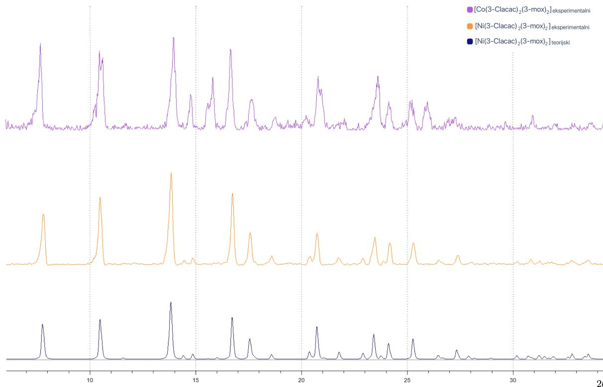
**D6.** Difraktogram polikristalnih uzorka sustava sa **3-moxpy** kao ligandom.  $[\text{Co}(\text{3-Cl-acac})_2(\text{3-moxpy})_2]$ , označen ljubičastom bojom, priređen je mehanokemijskom sintezom, dok je  $[\text{Ni}(\text{3-Cl-acac})_2(\text{3-moxpy})_2]$  (**2a**), priređen otopinskom sintezom. Tamnoplavom bojom označen je teorijski generiran difraktogram  $[\text{Ni}(\text{3-Cl-acac})_2(\text{3-moxpy})_2]$ .
