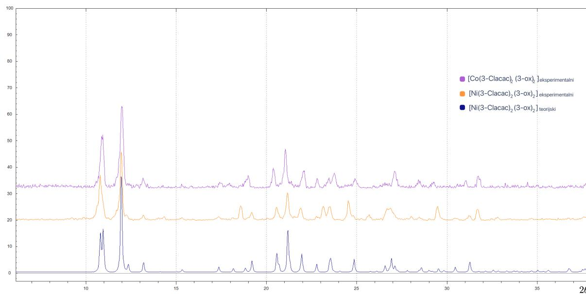
**D5.** Difraktogram polikristalnih uzorka sustava sa **3-oxpy** kao ligandom.  $[\text{Co}(\text{3-Cl-acac})_2(\text{3-oxpy})_2]$ , označen ljubičastom bojom, priređen je mehanokemijskom sintezom, dok je  $[\text{Ni}(\text{3-Cl-acac})_2(\text{3-oxpy})_2]$  (**1a**), priređen otopinskom sintezom. Tamnoplavom bojom označen je teorijski difraktogram spoja  $[\text{Ni}(\text{3-Cl-acac})_2(\text{3-oxpy})_2]$ .
