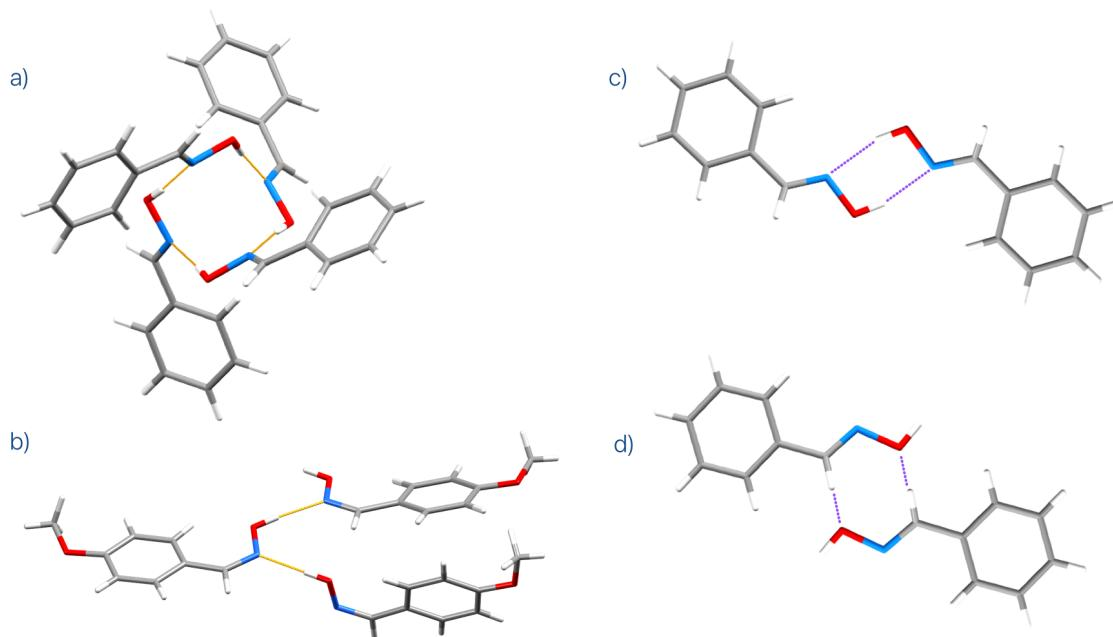
Slika 7. Raznovrsnost supramolekulskih motiva oksimskih skupina a) prstenasti  $R_4^2(12)$  motiv nastao povezivanjem O–H···N<sub>ox</sub> vodikovim vezama; b) motiv lanca C(3); c)  $R_2^2(6)$  homodimerni motiv d)  $R_2^2(8)$  homodimerni motiv.
