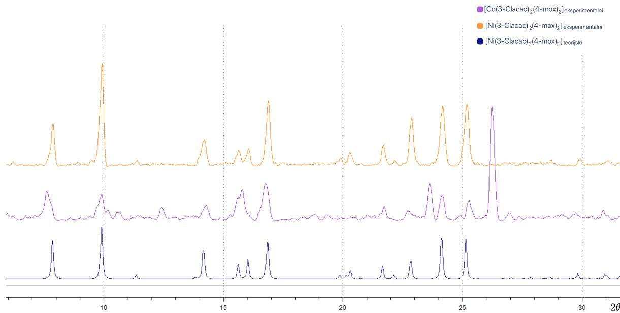
**D7.** Difraktogram polikristalnih uzorka sustava sa **4-moxpy** kao ligandom.  $[\text{Co}(3\text{-Cl-acac})_2(4\text{-moxpy})_2]$  (**3b**), označen ljubičastom bojom, priređen je mehanokemijskom sintezom, dok je  $[\text{Ni}(3\text{-Cl-acac})_2(4\text{-moxpy})_2]$  (**3a**), priređen otopinskom sintezom. Tamnoplavom bojom označen je teorijski generiran difraktogram  $[\text{Ni}(3\text{-Cl-acac})_2(4\text{-moxpy})_2]$ .
