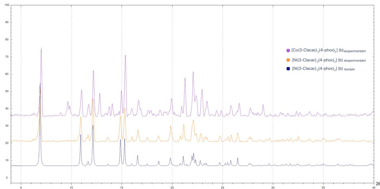
**D10.** Difraktogram polikristalnih uzorka sustava sa **4-phoxpy** kao ligandom.  $[Co(3-Cl-acac)_2(4-phoxpy)_2]$ , označen ljubičastom bojom, pripredjen je mehanokemijskom sintezom, dok je  $[Ni(3-Cl-acac)_2(4-phoxpy)_2]$  (**5a-II**), pripredjen otopinskom sintezom. Tamnoplavom bojom označen je teorijski generiran difraktogram  $[Ni(3-Cl-acac)_2(4-phoxpy)_2]$ \_b.
