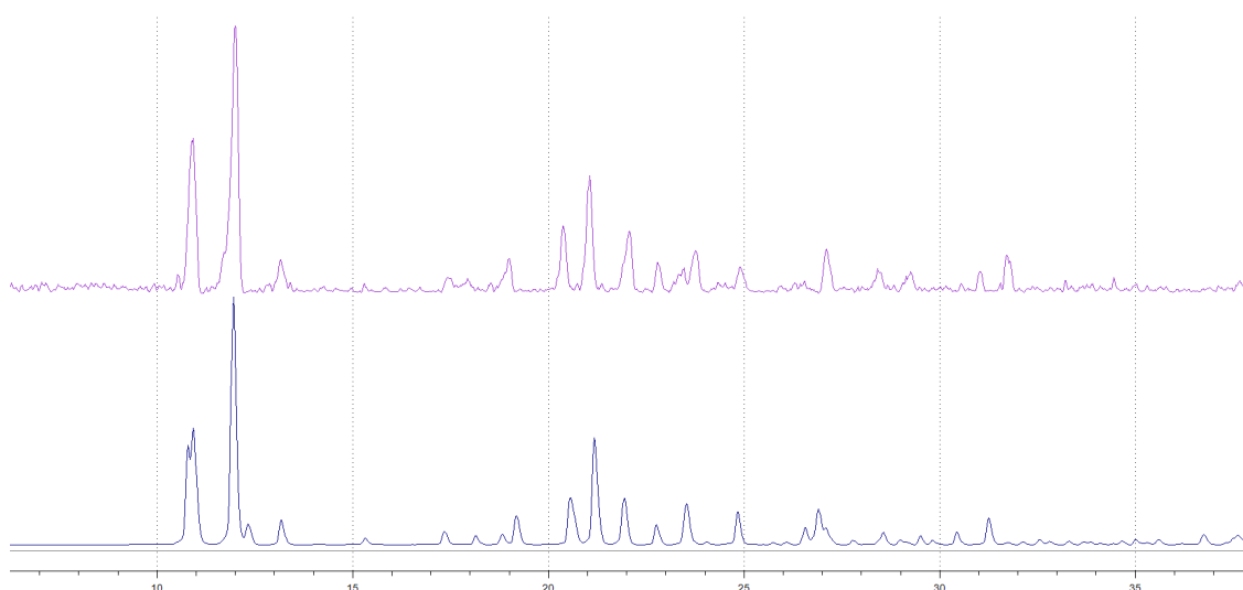
Slika 25. Usporedba difraktograma praha kobaltonih i niklovih analoga. Ljubičastom bojom označen je eksperimentalno određen difraktogram polikristalnog uzorka [Co(3-Clacac)_2(3-oxpy)_2] , dok je tanoplavom bojom označen je računati difraktogram spoja [Ni(3-Clacac)_2(3-oxpy)_2] , generiran pomoću programa Mercury.
