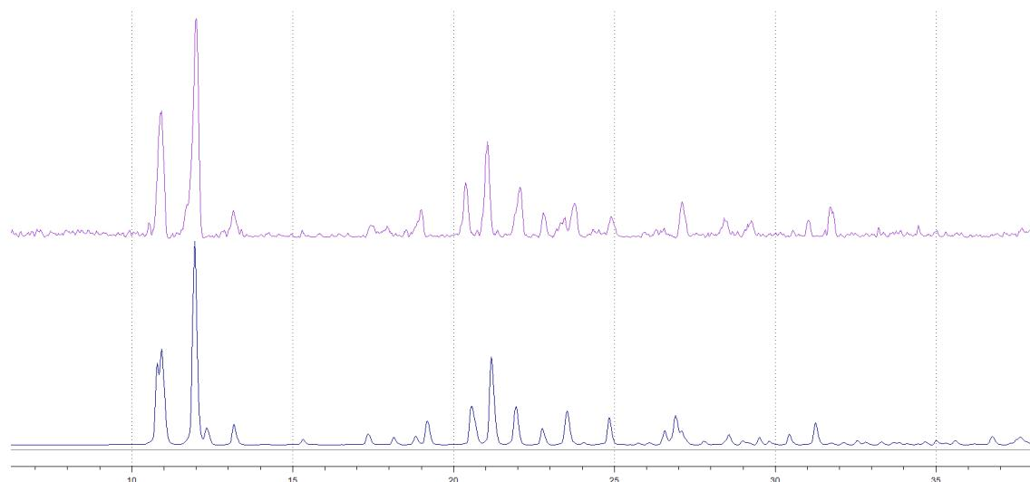
Slika 25. Usporedba difraktogrami praha kobaltovih i niklovih analoga. Ljubičastom bojom označen je eksperimentalno određen difraktogram polikristalnog uzorka  $[Co(3-\text{Clacac})_2(3-\text{oxpy})_2]$ , dok je tanoplavom bojom označen je računati difraktogram spoja  $[Ni(3-\text{Clacac})_2(3-\text{oxpy})_2]$ , generiran pomoću programa Mercury.
