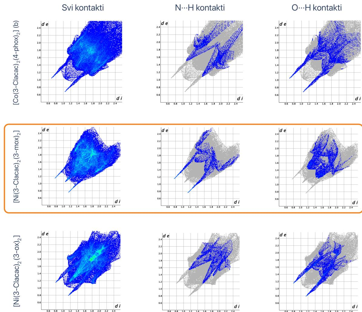
**D27.** Grafovi „otiska prsta“ za odabrane bliske međumolekulske kontakte dobivenih kristalnih struktura. Narančasto su označeni grafovi koji pripadaju strukturama koje ostvaruju O–H···N kontakte, odnosno  $R_2^2(6)$  supramolekulski motiv.
