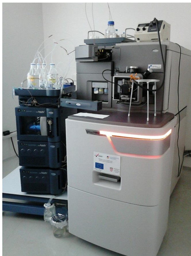
Slika 2.8. Spregnuti sustav spektrometar masa visoke rezolucije SYNAPT G2-Si (Waters, Milford, MA, SAD) s kromatografskim sustavom nanoACQUITY UPLC (Waters, Milford, MA, SAD).
