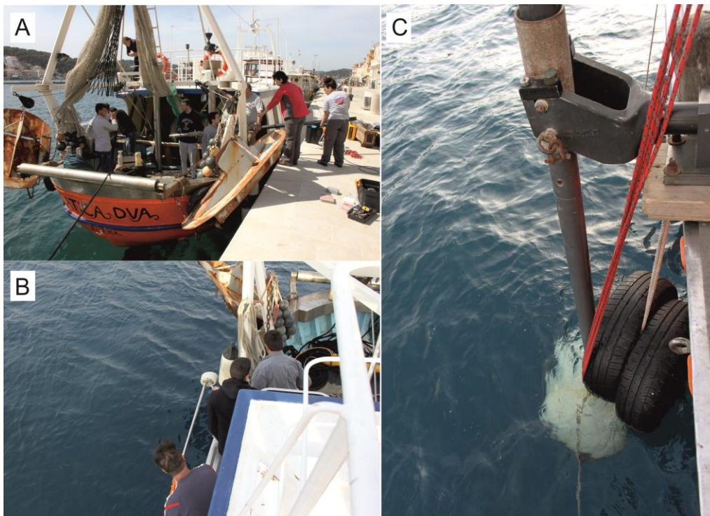
Slika 12: A) plovilo „Zlatica Dva“, B) postavljanje 3,5 kHz geološkog dubinomjera ORE Pinger , C) geološki dubinomjer ORE Pinger .
