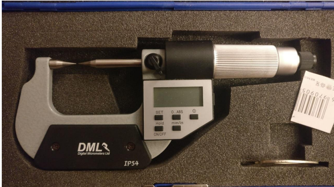
Slika 19. Mikrometar korišten za mjerenje širine glave jedinki Sympetrum fonscolombei .
