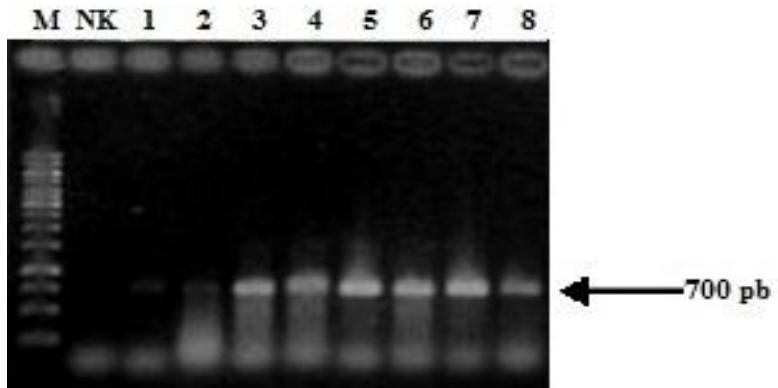
Slika 16 Detekcija gena *AtILR1* umnoženog rekocijom PCR u divljem tipu, jednostrukim, dvostrukoj i trostrukoj mutanti, na 1% agaroznom gelu. M – marker, NK – negativna kontrola, 1-2 – divlji tip (*A.thaliana* ekotip WS), 3 –mutanta (*ilr1-1*) , 4 –*iar3-2*, 5 – mutanta *ill2-1*, 6 – dvostruka mutanta (*ill2-1/iar3-2*), 7-8 – trostrukje mutante (*ilr1-1/ill2-1/iar3-2*).
