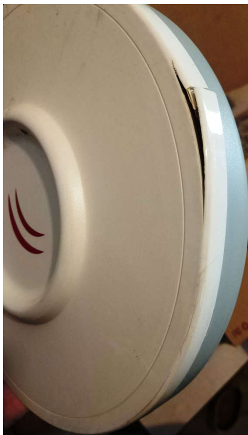
Slika 3.1 Odašiljač oštećen temperaturnim razlikama
