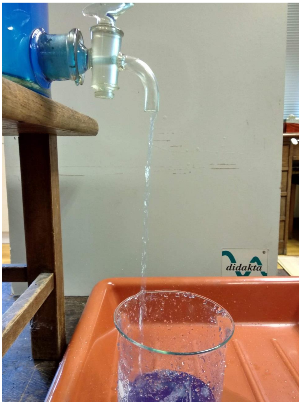
Slika 16.: Tok vode kod malog otvora slavine (pri velikom otporu).
