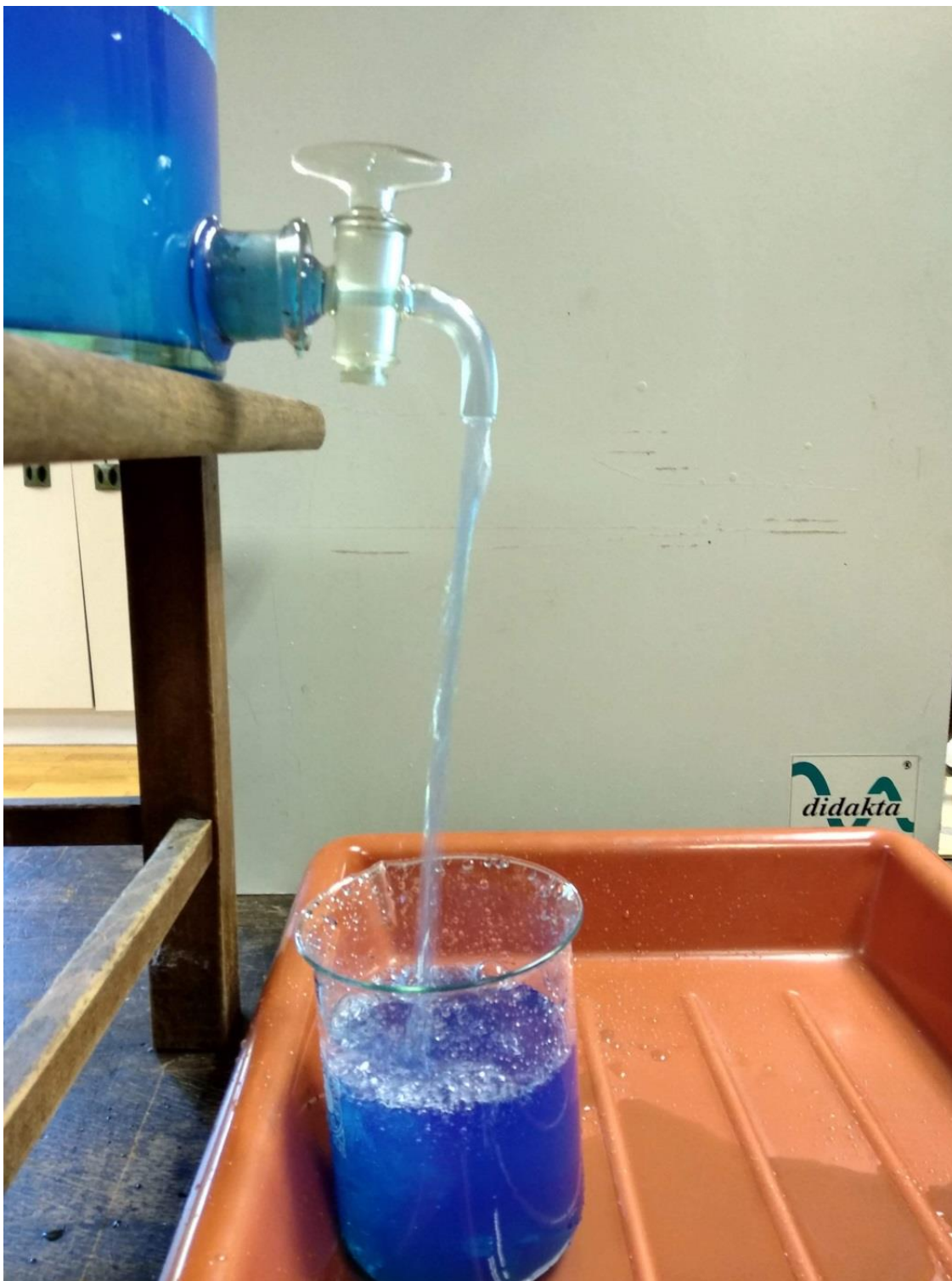
Slika 17.: Tok vode pri velikom otvoru slavine (pri malom otporu).
