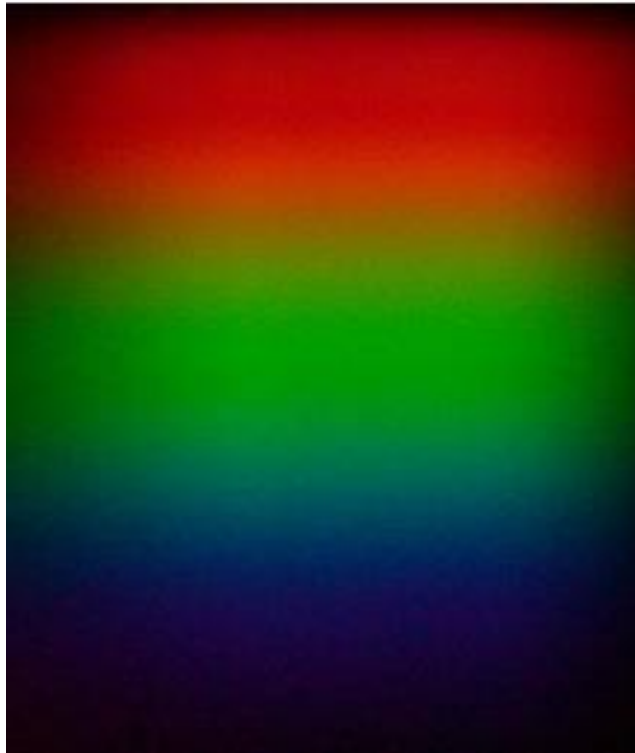
Slika 15.: Spektar žarulje sa žarnom niti.
