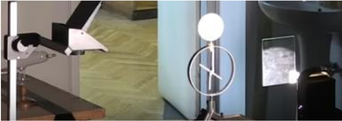
Slika 6.: Demonstracija otklona listića elektroskopa na zidu.
