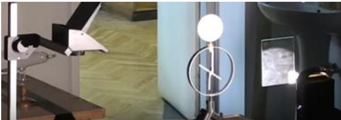
Slika 6.: Demonstracija otklona listića elektroskopa na zidu.
