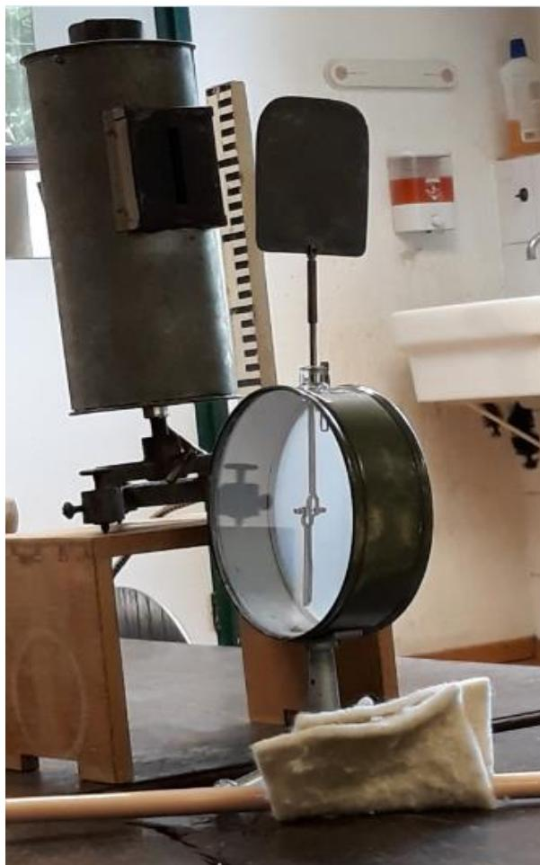
*Slika 4.: Postav za demonstraciju fotoelektričnog efekta na fakultetu.*
