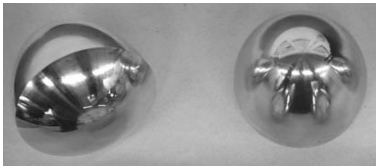
Slika 4.3: Tijelo konstantne širine nastalo rotacijom Reuleauxovog četverokuta
