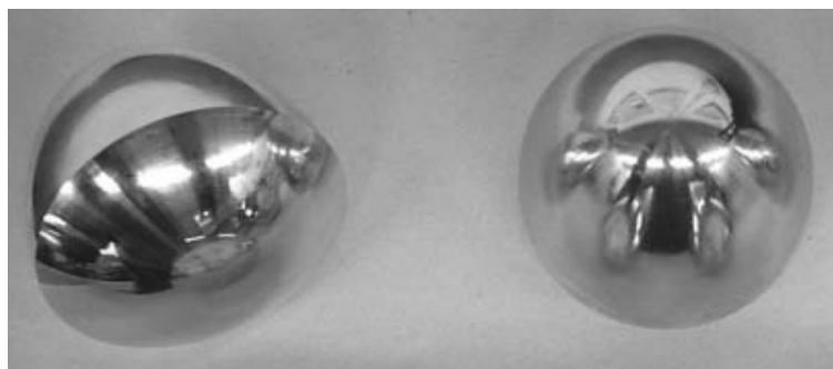
Slika 4.3: Tijelo konstantne širine nastalo rotacijom Reuleauxovog četverokuta
