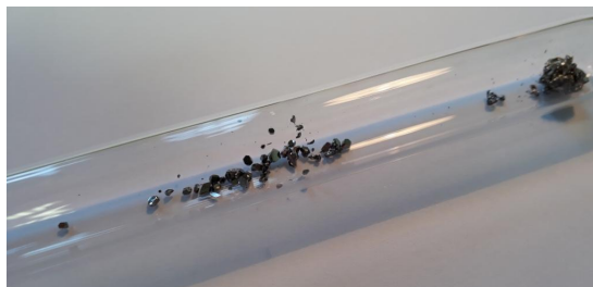
Slika 5.1.3: Fotografija ampule s Cd 3 As 2 nakon završene sinteze. Izrasli kristali su izolirani i koncentrirani su oko sredine ampule, gdje je u trenutku početka sublimacije početnog materijala temperatura bila najniža.
