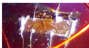
Slika 3.4.1: Fotografija uzorka Sn:Bi 1.1 Sb 0.9 Te 2 S na nosaču. Kontakti su napravljeni srebrnom pastom u konfiguraciji za mjerenje longitudinalnog MR i Hallovog napona.
