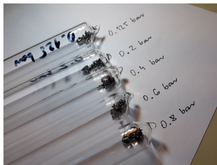
Slika 5.1.4: Fotografija ampula s početnim materijalom prije sinteze. U ampule je nakon ispumpavanja dodan argon.
