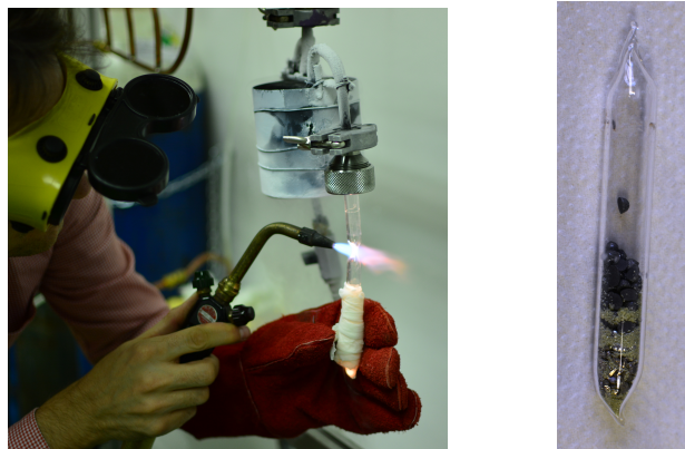
Slika 3.1.1: Zataljivanje kvarcne cijevi u ampulu (lijevo). Ampula s elementima u kojoj je vakuum od \sim 10^{-6} mbar (desno).
