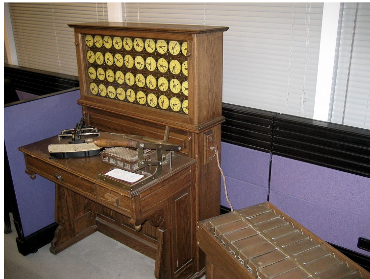
Slika 1: Elektromehanički tabulator Hermana Holleritha. Izvor: [1]
