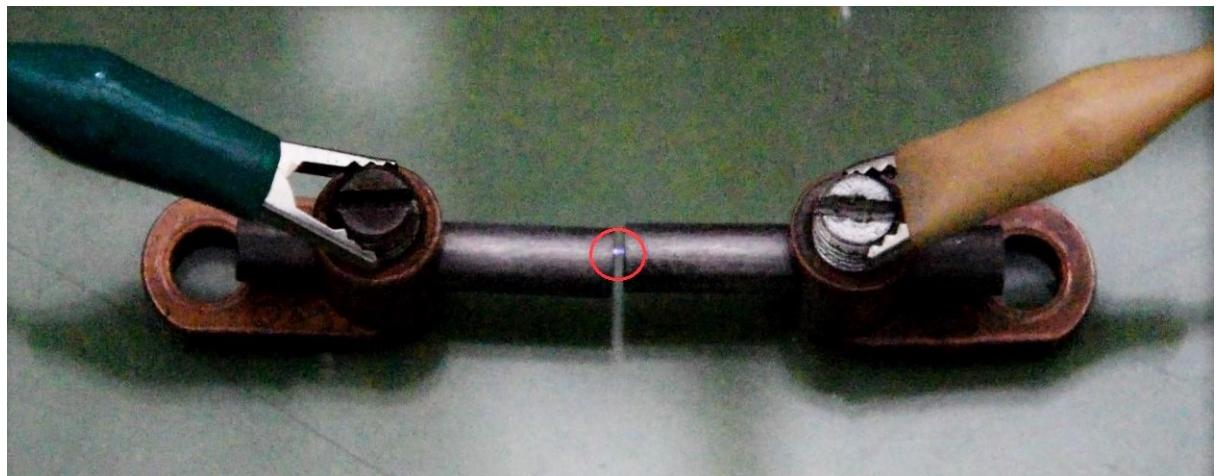
Slika 3.1: Iskra koja nastaje savladavanjem dielektrične snage zraka.
