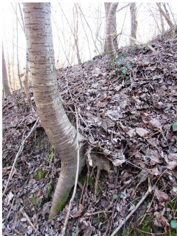
Sl. 34 Deformacija debala uslijed procesa puženja na haldi 10 (10. 12. 2014.)
