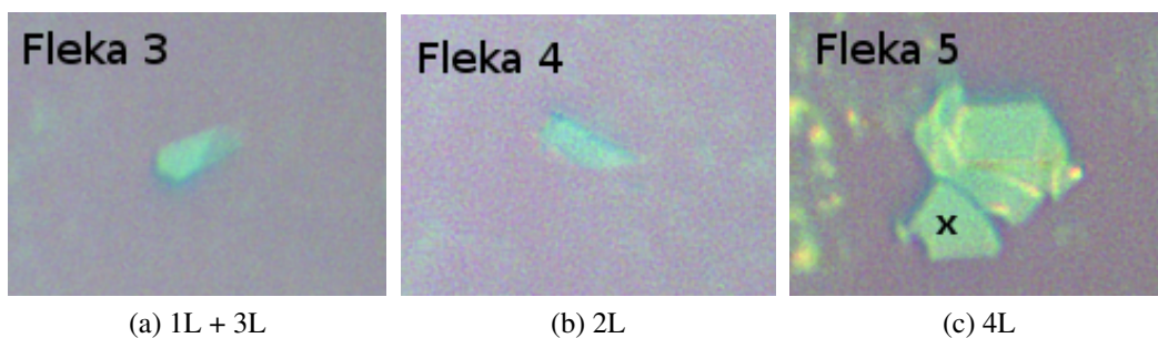
Slika 3.8: Eksfolirani uzorci WSe_2 . "X" označava položaj na uzorku gdje se snimao Raman spektar prikazan na Slici 3.9.
