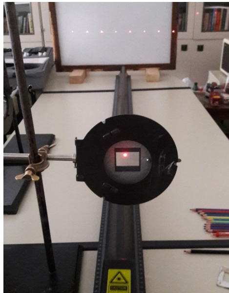
Slika 5.5: Postav za optičku rešetku od 80 zarez/mm
