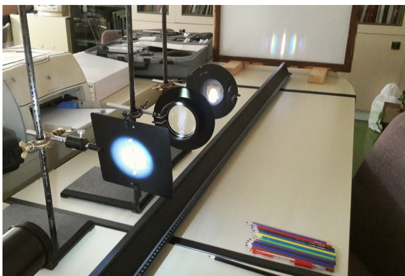
Slika 5.7: Postav za optičku rešetku s izvorom bijele svjetlosti
