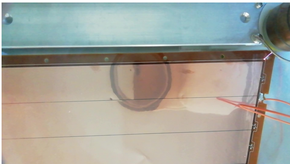
Slika 5.17: Napon je na GEM-u, a ostatak je uzemljen, udaljenost žica-GEM \approx 9 mm, izboj na 5 kV.
