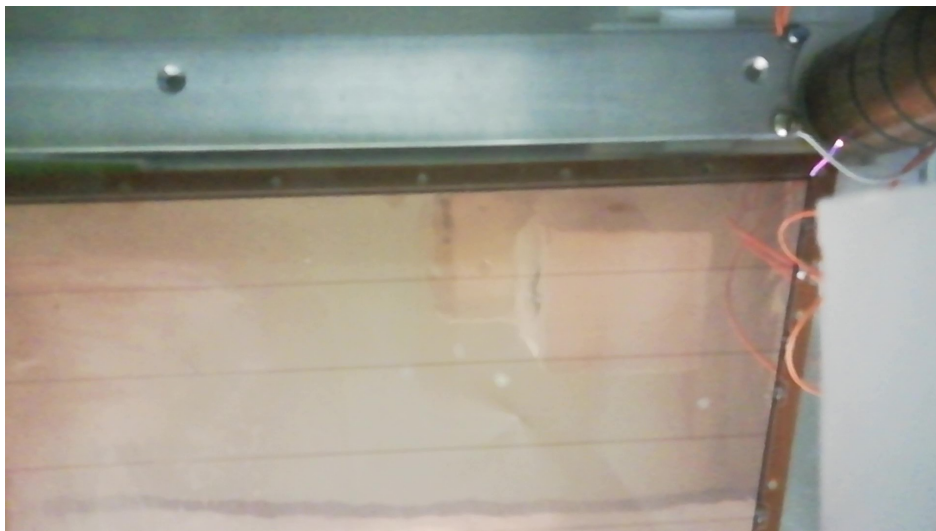
Slika 5.13: Napon je na šipci i “skirt”-u, a GEM je uzemljen, udaljenost GEM-šipka \approx 13 mm, izboj na 6.5 kV.
