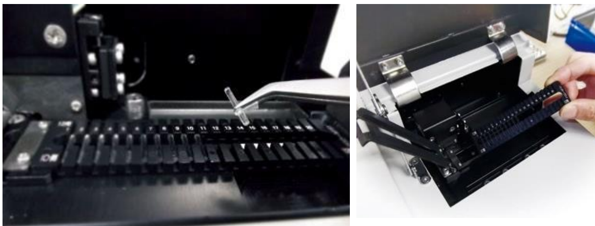
Slika 3.4 Postavljanje staklenih detektora u plastični stalak (lijevo) koji se umeće u RPL čitač (desno) [17]
