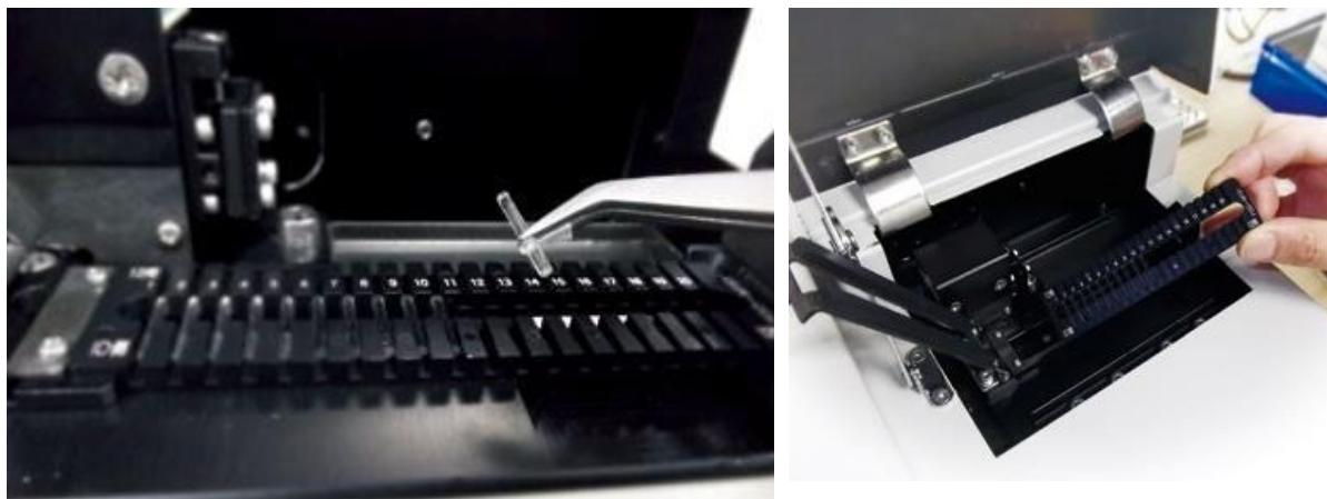
Slika 3.4 Postavljanje staklenih detektorâ u plastični stalak (lijevo) koji se umeće u RPL čitač (desno) [17]
