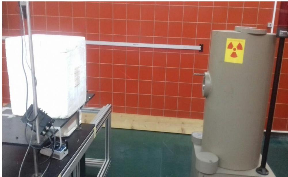
Slika 3.8 Prikaz izvora gama zračenja  $^{137}\text{Cs}$  i kocke od stiropora na koju su pričvršćeni dozimetri
