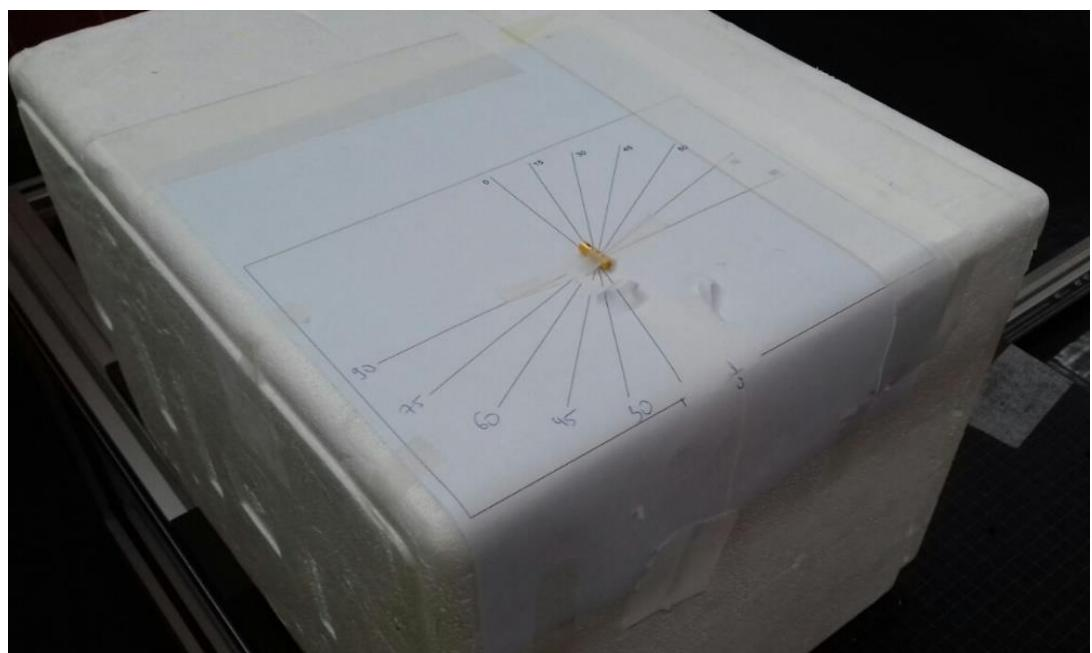
Slika 3.11 Eksperimentalni postav za mjerjenje kutne ovisnosti
