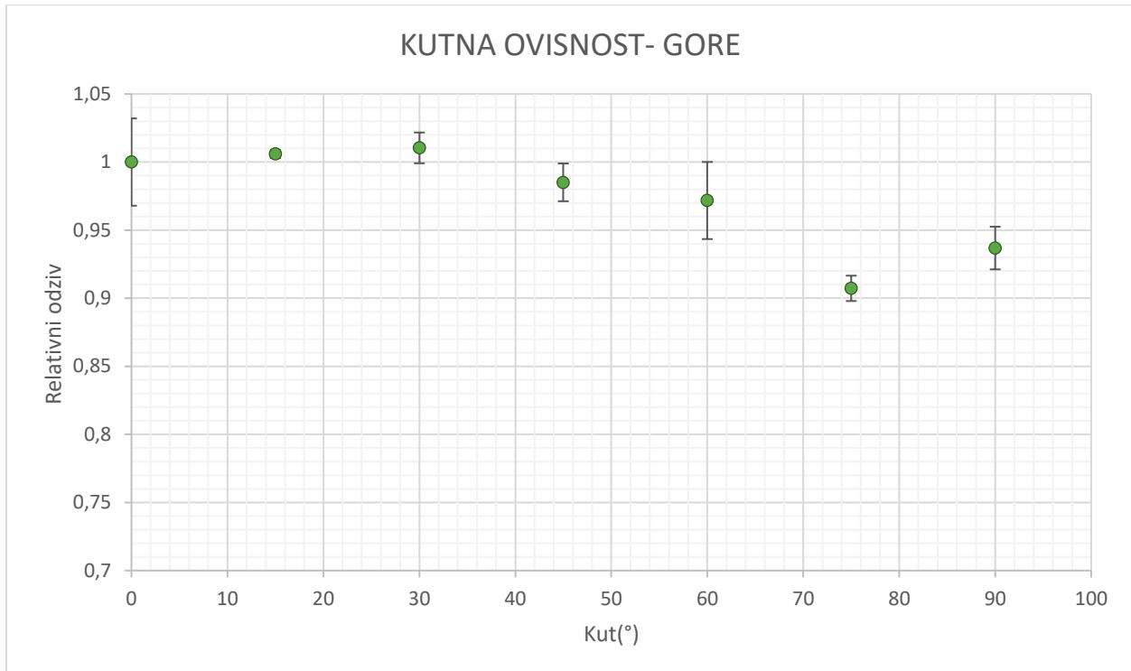
*Slika 4.7 Kutna ovisnost za dozimetre stavljeni na vrh kutije od stiropora prilikom zračenja na izvoru  $^{137}\text{Cs}$*
