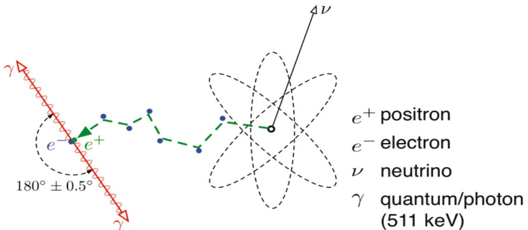
Slika 2.3 Prikaz pozitrona i elektronskog nutrina koji su nastali  $\beta^+$  raspadom (desno) Pozitron se nasumično giba materijalom i gubi energiju te se na kraju anihilira s elektronom (lijevo) [7]
