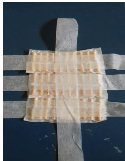
Slika 3.9 Dozimetri pripremljeni za ozračivanje
