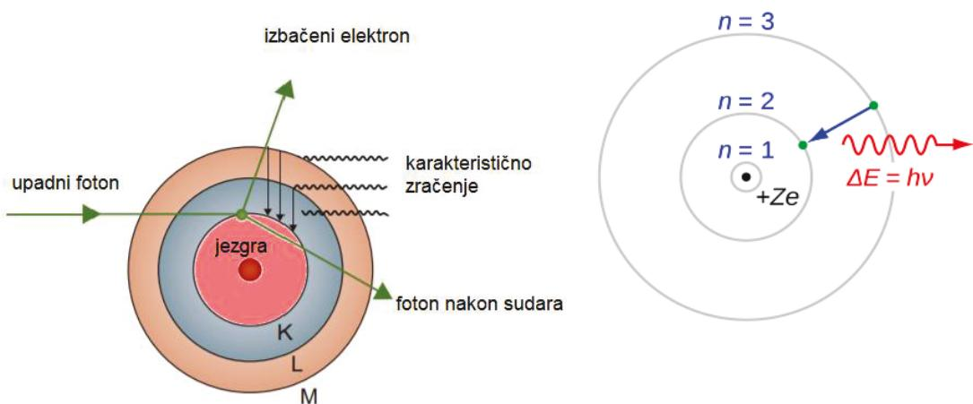
Slika 2.2 Nastanak karakterističnog X-zračenja nakon izbacivanja orbitalnog elektrona (lijevo) Prijelaz elektrona iz višeg energetskog stanja u M-ljusci ( $n=3$ ) u prazno stanje (šupljinu) u nižoj L-ljusci ( $n=2$ ). Energija emitiranog fotona karakterističnog X-zračenja jednaka je razlici energija početnog i konačnog stanja ( $\Delta E = E_3 - E_2$ ) (desno) [3]
