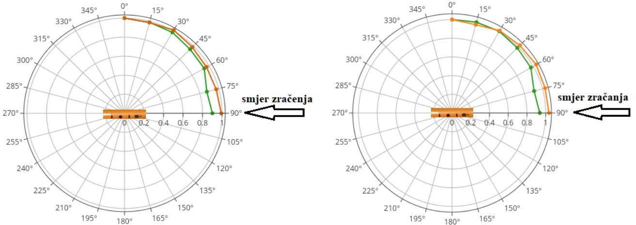
Slika 4.14 Usporedba mjerenja na  $^{137}\text{Cs}$  (zelena krivulja) i  $^{60}\text{Co}$  (narančasta krivulja). Lijevo dozimetri na bočnoj strani, desno dozimetri gore
