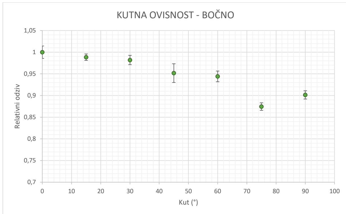
Slika 4.6 Kutna ovisnost za dozimetre stavljenе bočno na kutiji od stiropora prilikom zračenja na izvoru  $^{137}\text{Cs}$
