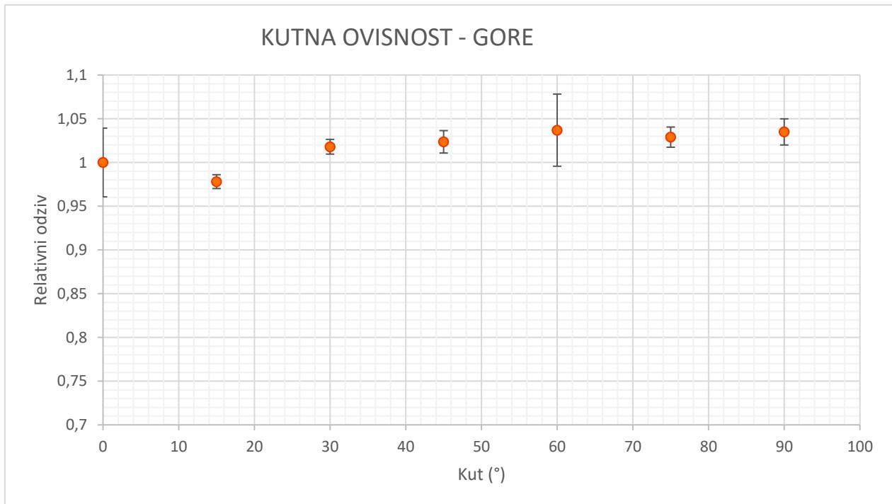
*Slika 4.10 Kutna ovisnost za dozimetre stavljenе na vrh kutije od stiropora prilikom zračenja na izvoru  $^{60}\text{Co}$*
