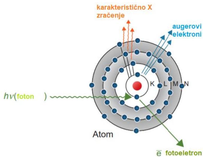
Slika 2.9 Fotoelektrični učinak i procesi koji mogu slijediti [3]
