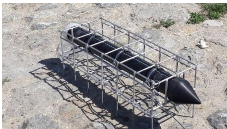
Slika 9. Pasivno uzorkovalo korišteno na lokaciji Prisavlje (TMPB)
