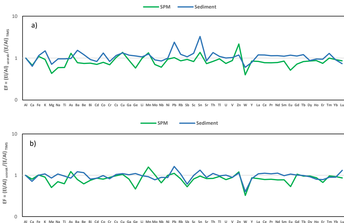
Slika 101. Dvostruka normalizacija geokemijskog sastava uzorka sedimenta i jednokratnog uzorka SPM-a rijeke Ljubljanice; a) uzorkovanje u siječnju i veljači (TMLJ1), b) travnju i svibnju (TMLJ2) 2017. godine na lokaciji Podgrad (jednokratni uzorak SPM – 1 uzorak, sediment – 1 uzorak)
