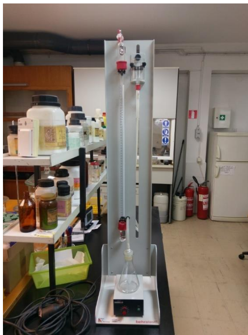
Slika 6.2: Kalcimetar (CM1 Calcimetar, Hrvatski geološki institut, Zavod za geologiju)
