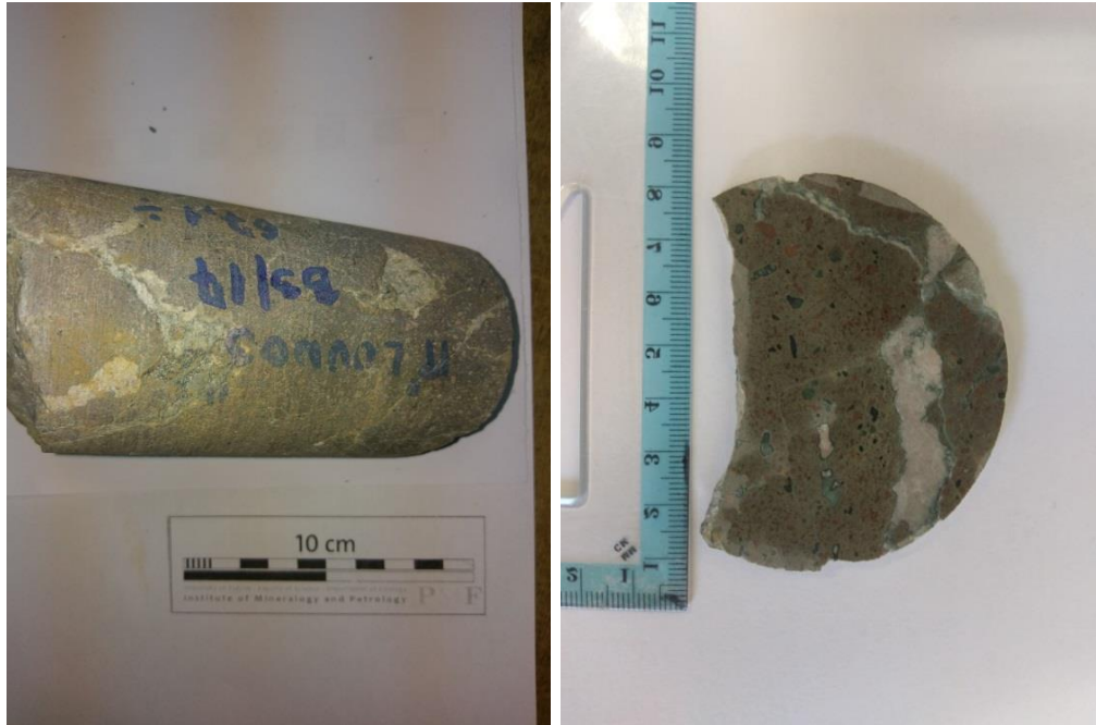
Slika 7.32: Fotografija jezgre uzorka u8 (lijevo) i izdvojeni fragment pločice od kojeg je napravljen mikroskopski preparat (desno).
