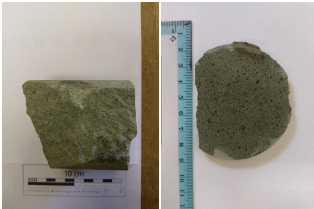
Slika 7.1: Fotografija jezgre uzorka u1 (lijevo) i izdvojene pločice od koje je napravljen mikroskopski izbrusak, preparata (desno).
