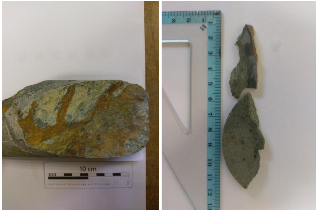
Slika 7.5: Fotografija jezgre uzorka u2 (lijevo) i izdvojeni fragmenti pločice od kojih je napravljen mikroskopski izbrusak (desno).
