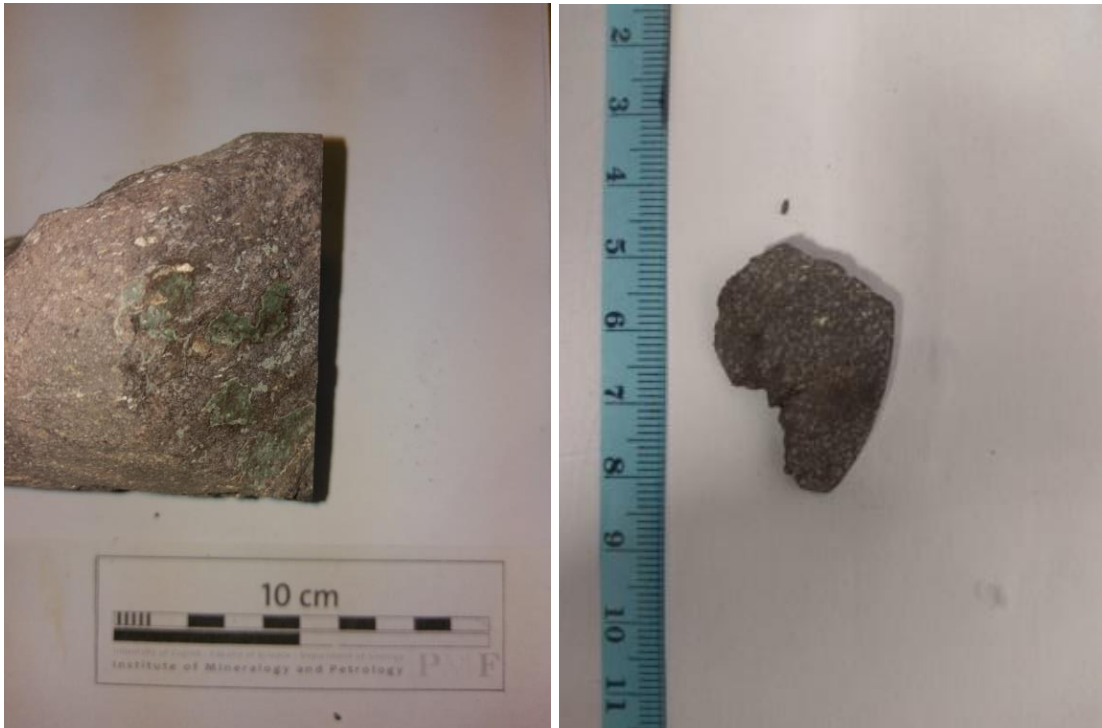
Slika 7.43: Fotografija jezgre uzorka u11 (lijevo) i izdvojeni fragment pločice od kojeg je napravljen mikroskopski izbrusak (desno).
