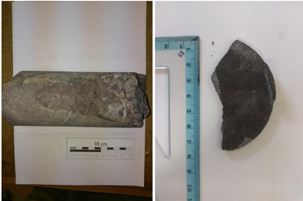
Slika 7.18: Fotografija jezgre uzorka u5 (lijevo) i dio pločice od kojeg je napravljen mikroskopski preparat (desno).
