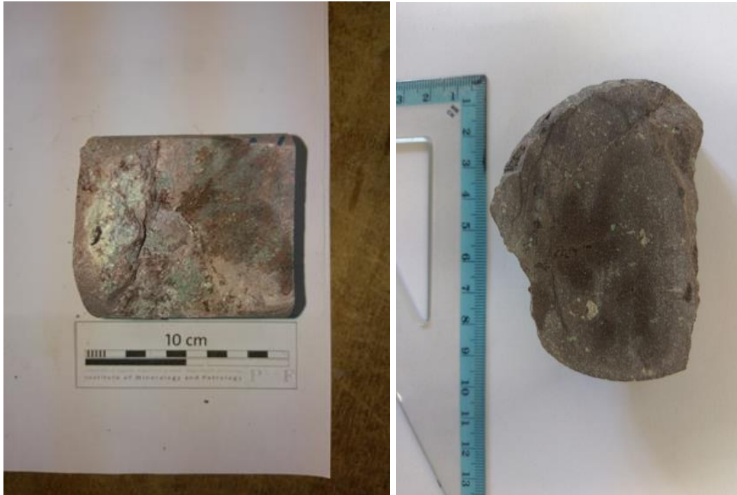
Slika 7.47: Fotografija jezgre uzorka u12 (lijevo) i izdvojeni fragment pločice od kojeg je napravljen mikroskopski izbrusak (desno).
