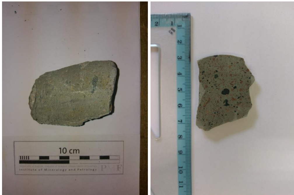
Slika 7.26: Fotografija jezgre uzorka u7 (lijevo) i izdvojeni fragment pločice od kojeg je napravljen mikroskopski izbrusak (desno).
