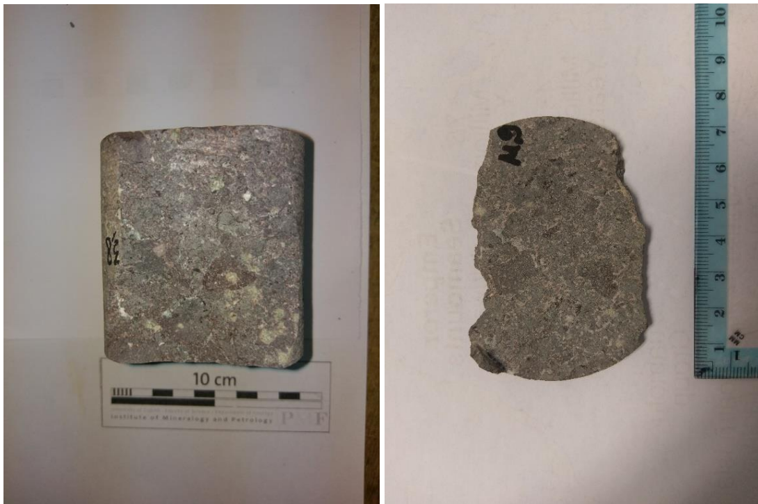
Slika 7.36: Fotografija jezgre uzorka u9 (lijevo) i pločice iz kojeg je izrađen mikroskopski izbrusak (desno).
